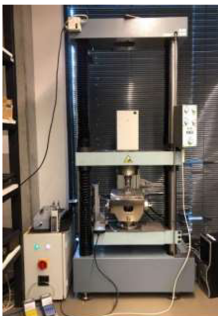
Obr. 26 Trhací zařízení TIRA Test 2300
