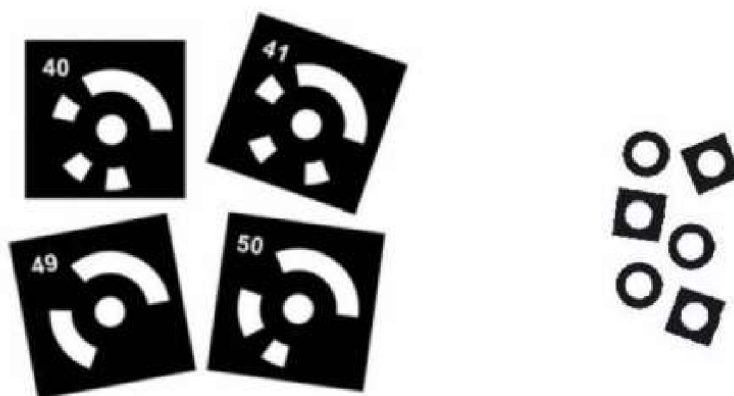
Obr. 20 Kódované (vlevo) a nekódované (vpravo) body [23]
