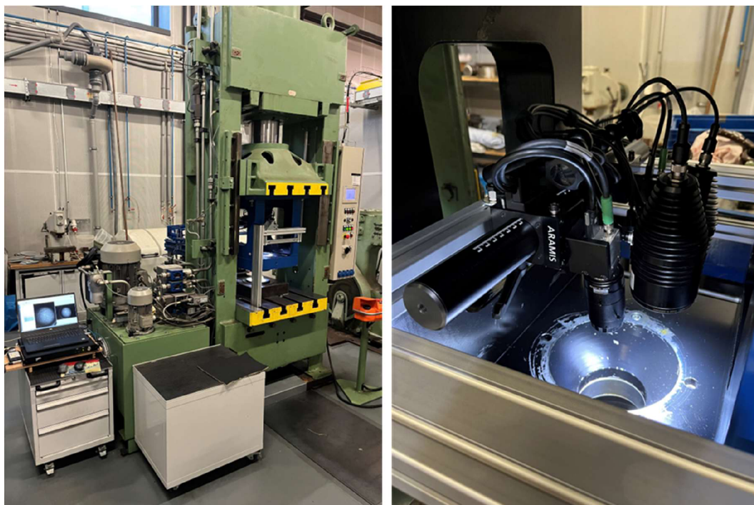
Obr. 31 Hydraulický dvojčinný lis CBA 300/63 (vlevo) a měřicí systém GOM Correlate Pro (vpravo)
