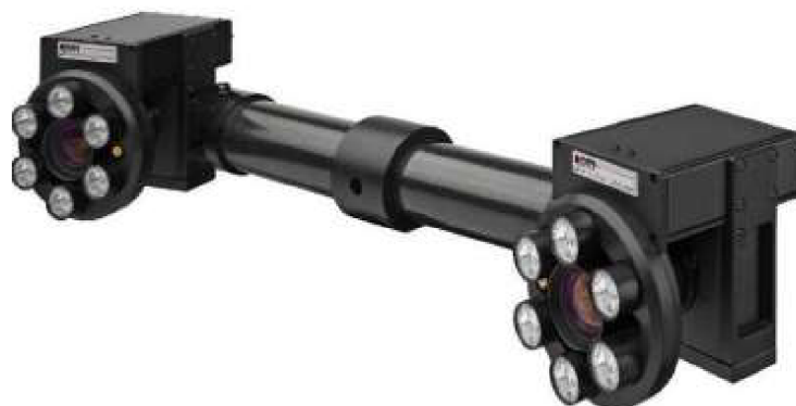
Obr. 21 Dvojice kamer systému PONTOS [23]
