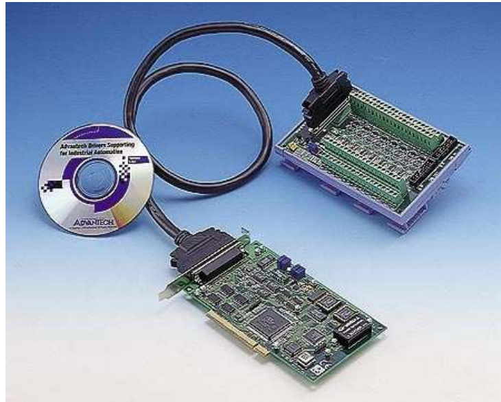
Obr. 20 – Multifunkční karta Advantech PCI-1711 [33]
