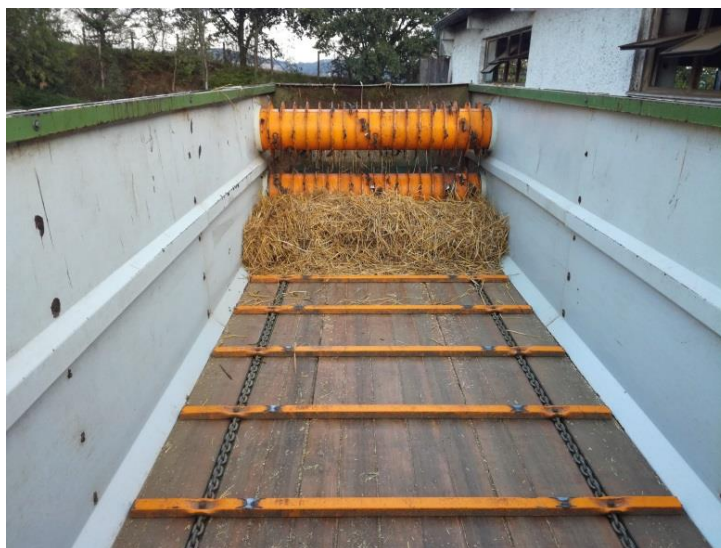
Obrázek 29 – Podélný hrabicový dopravník nastýlacího vozu Kamzík MAXI
