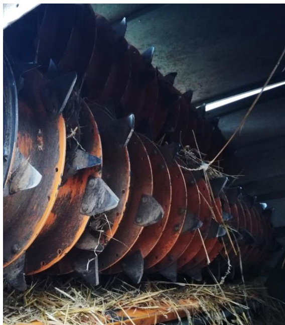
Obrázek 30 – Rozdružovací válce s noži nastýlacího vozu Kamzík MAXI
