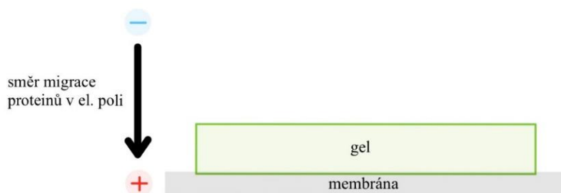
Obr.12. Schéma elektropřenosu. Vytvořeno v programu Goodnotes.
