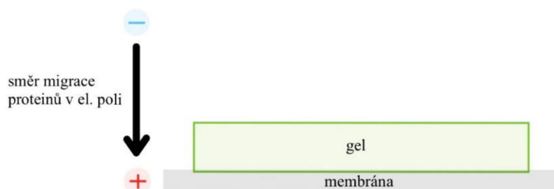
Obr.12. Schéma elektropřenosu. Vytvořeno v programu Goodnotes.
