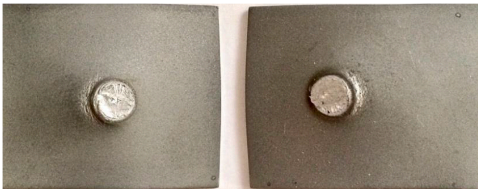
Obrázek 31 – Porušení svarové čočky
