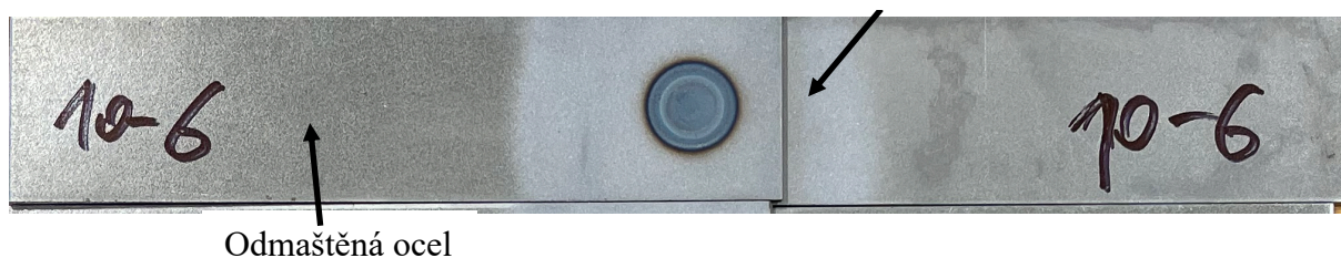
Obrázek 27 – Vzorek svařeného spoje – svařovací čas 10 (1,3 s) vzorek č. 6
