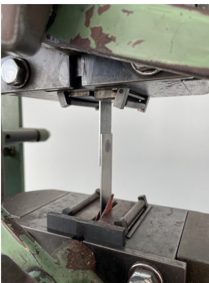
Obrázek 30 – Upnutí vzorku svarového spoje v upínacích čelistech
