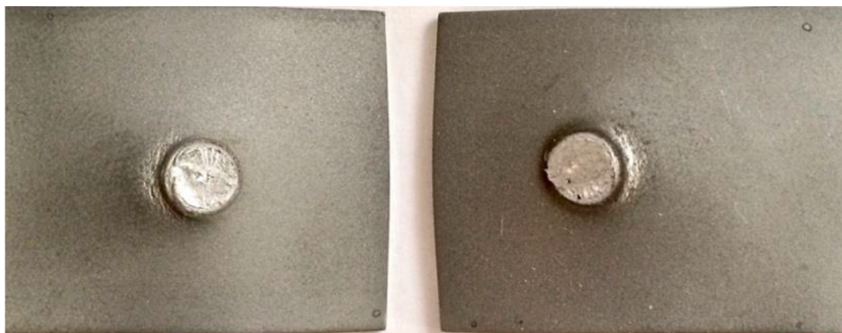
Obrázek 31 – Porušení svarové čočky
