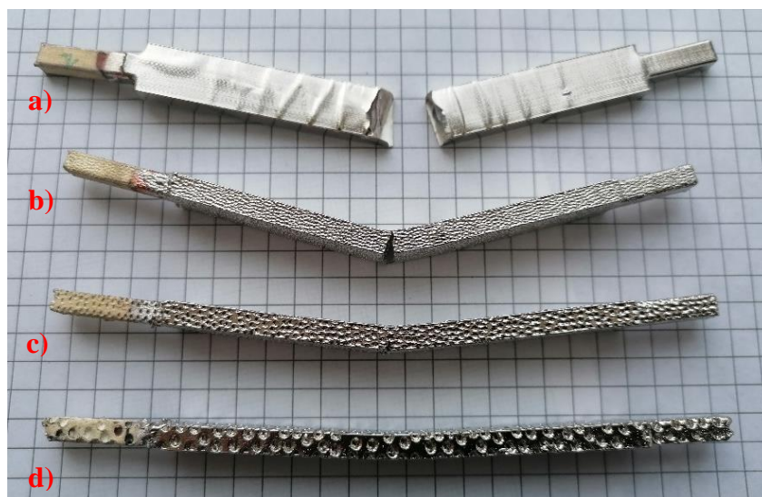
Obr. 54 Příklady zkušebních těles struktur polymer – kov z materiálu High Temp V1 po zkoušce v ohybu; a) bez textury, b) E-d0,5-1(SLA), c) E-d1-1(SLA), d) K-d2-1(SLA)
