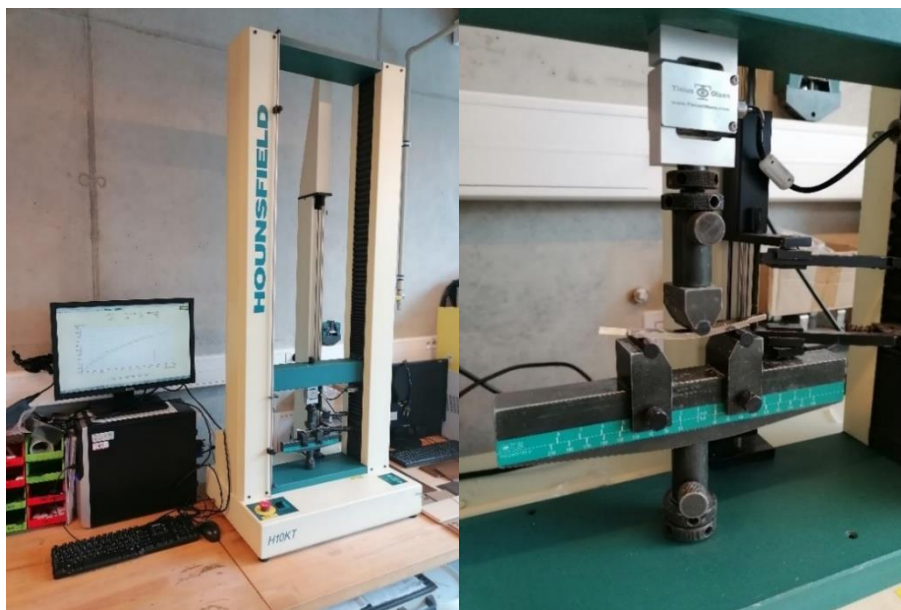
Obr. 38 Ohybové zkušební zařízení HOUNSFIELD H10KT (vlevo), detail průběhu ohybové zkoušky (vpravo)
