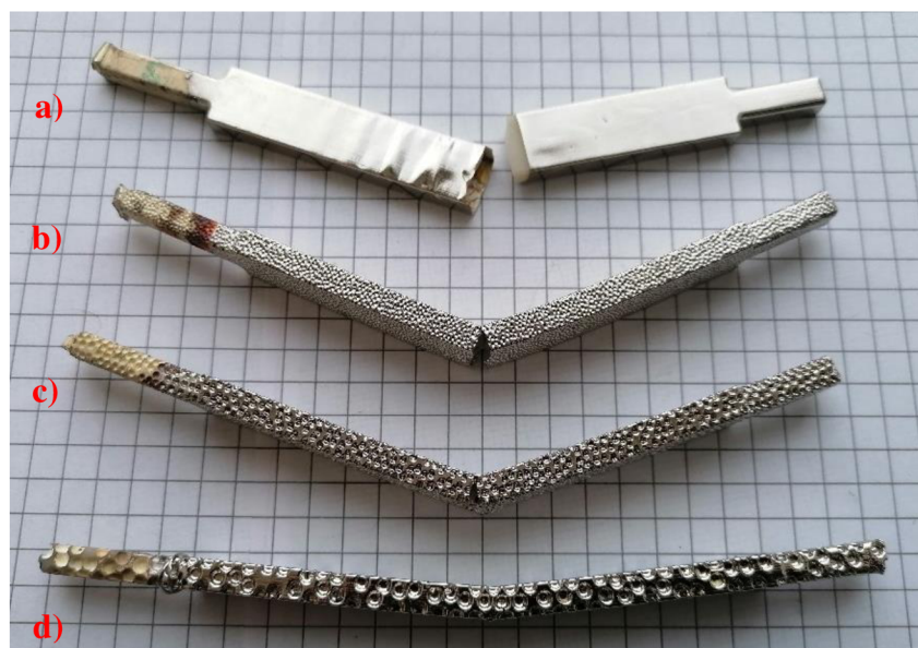
Obr. 55 Příklady zkušebních těles struktur polymer – kov z materiálu Prusa Tough Resin po zkoušce v ohybu; a) bez textury, b) C-d0,5-1(SLA), c) E-d1-1(SLA), d) K-d2-1(SLA)
