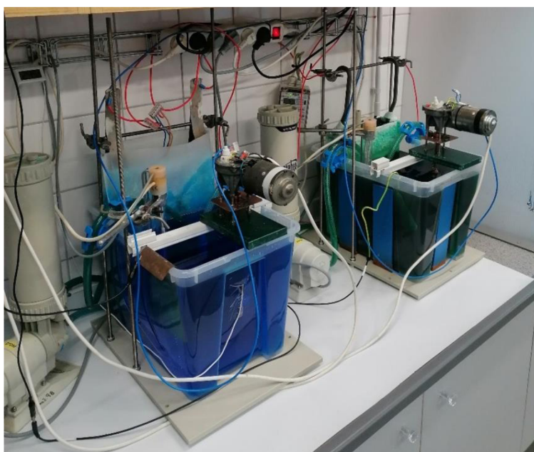
Obr. 33 Pracoviště galvanických (mědicích a niklovacích) lázní v průběhu pokovování
