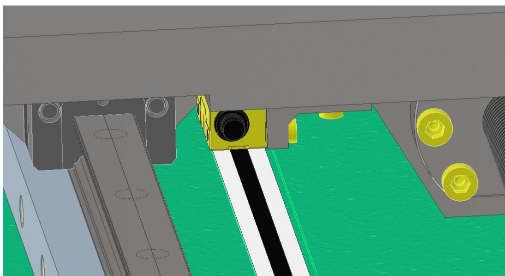
Obr. 39 Umístění odměrovacího systému
