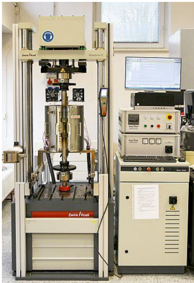
Obr. 5.1: Fotografie rezonančního pulsátoru ZwickRoell Vibrophore (vlevo) [25] a fotografie ocelových vzorků připravených na únavové testování (vpravo)
