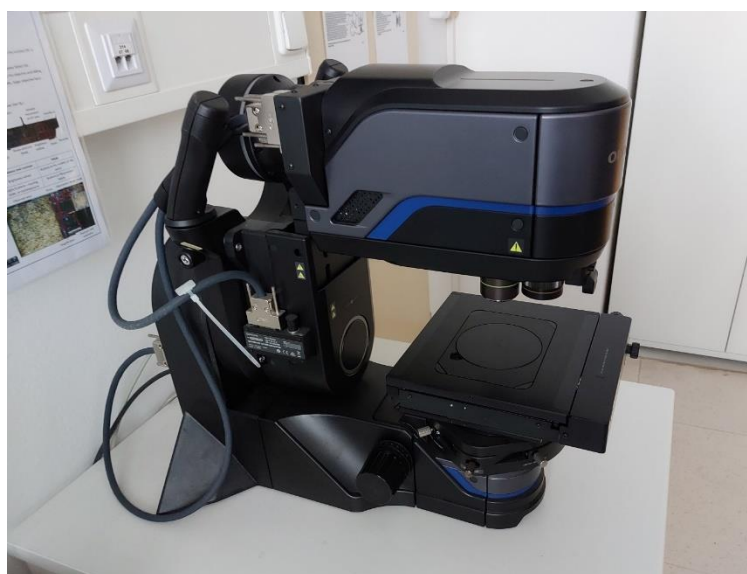
Obr. 7.1: Fotografie digitálního mikroskopu Olympus DXS 1000
