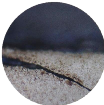
b) Transkrystalová koroze
