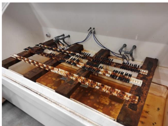
Obr. 3.2: Fotografie umístění vzorků v komoře
