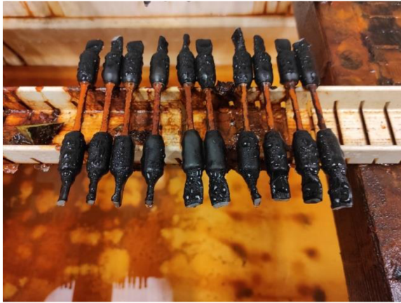
Obr. 3.3: Fotografie detailu uložení vzorků vystavených korozi
