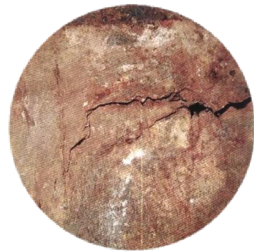
c) Korozní únava
