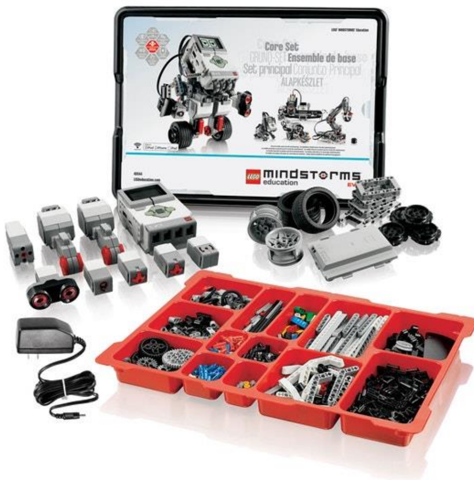
Obrázek 1 Edukační sada konstrukční robotické stavebnice Lego Mindstorms EV3 obsahuje řídicí jednotku, motory, různé senzory a konstrukční díly [6].
