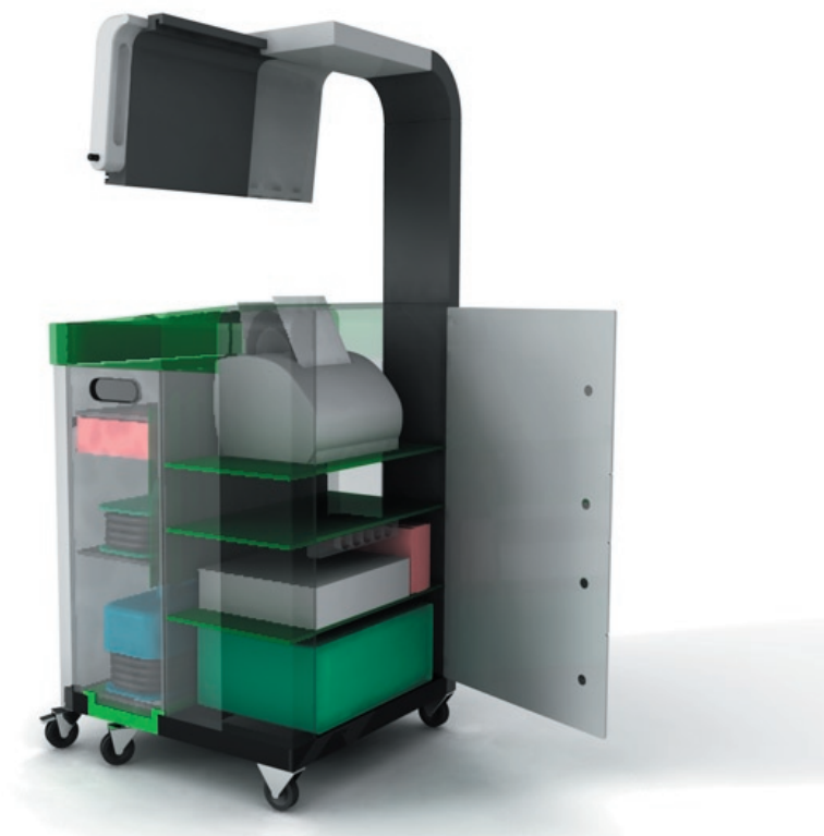
Obr. 3.12b Průhledový obraz základního uspořádání funkčních částí motor-testeru. Na nosném rameni: LCD monitor a vyjímatelný touchscreen modul; v zadní části testeru: tiskárna s plněním a výdejem papíru v horní desce, skříň PC, UPC a infraanalýzátor.
