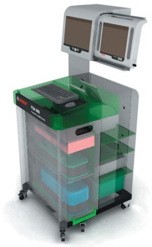
Obr. 3.12a Průhledový obraz základního uspořádání funkčních částí motor-testeru. Na nosném rameni: LCD monitor a vyjímatelný touchscreen modul; v horní desce skříňě: klávesnice+myš; ve výsuvém dílenském vozíku: osciloskop s příslušenstvím, zásuvka na nářadí, cívka s hadicí pro infraanalýzátor a opacimetr s cívkou a hadicí.
