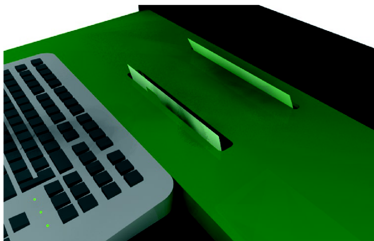
Obr. 5.6 Detail otvoru podavače a zásobníku papíru
