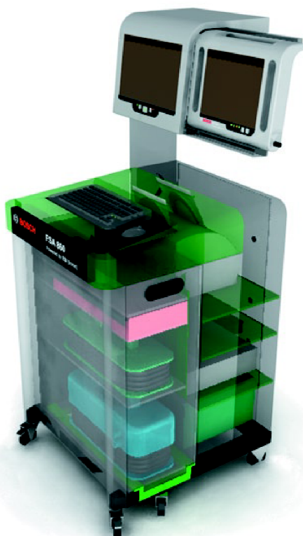
Obr. 3.12a Průhledový obraz základního uspořádání funkčních částí motor-testeru. Na nosném rameni: LCD monitor a vyjímatelný touchscreen modul; v horní desce skříně: klávesnice+myš; ve výsuvém dílenském vozíku: osciloskop s příslušenstvím, zásuvka na nářadí, cívka s hadicí pro infraanalýzátor a opacimetr s cívkou a hadicí.
