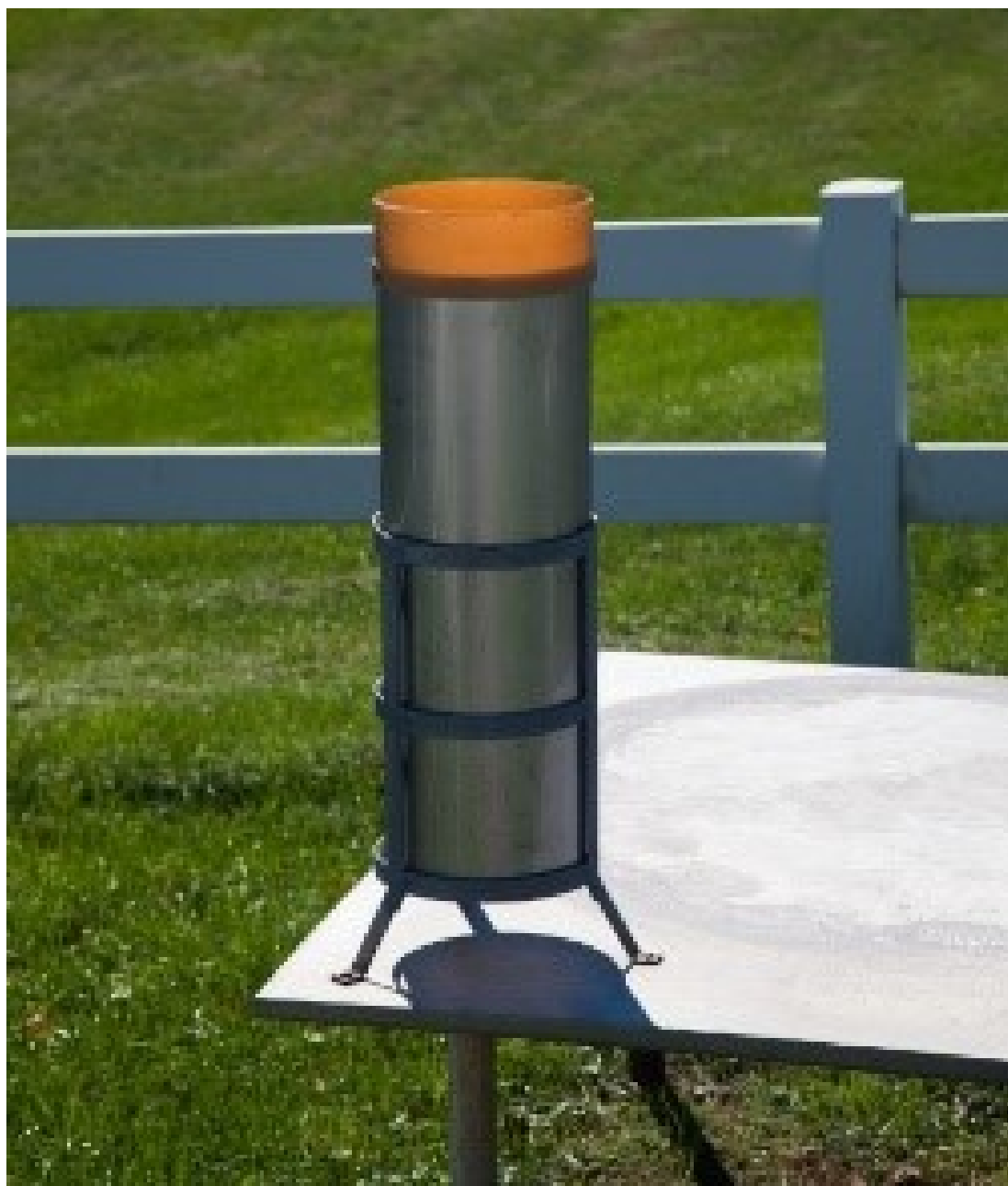
Obrázek 3.2: Srážkoměry k měření celkového úhrnu deště i sněhu. [26]
