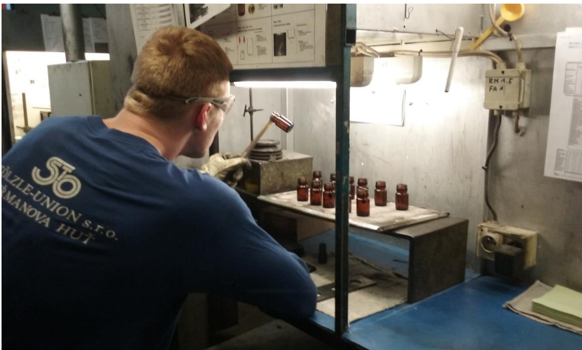
Příloha č. 4: Kontrola lahviček na kontrolním stanovišti- vizuální kontrola
