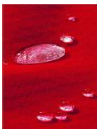
Obr. 2 Vodoodpudivá úprava 3XDRY
