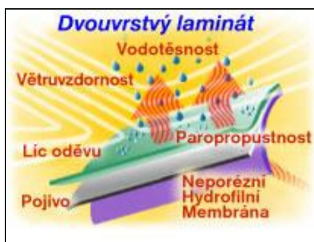
Obr. 45 Dvouvrstvý laminát – schéma
