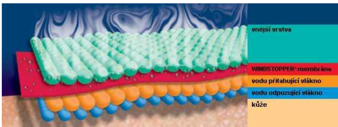
Obr. 40 Jednotlivé vrstvy z oblečení WINDSTOPPER®
