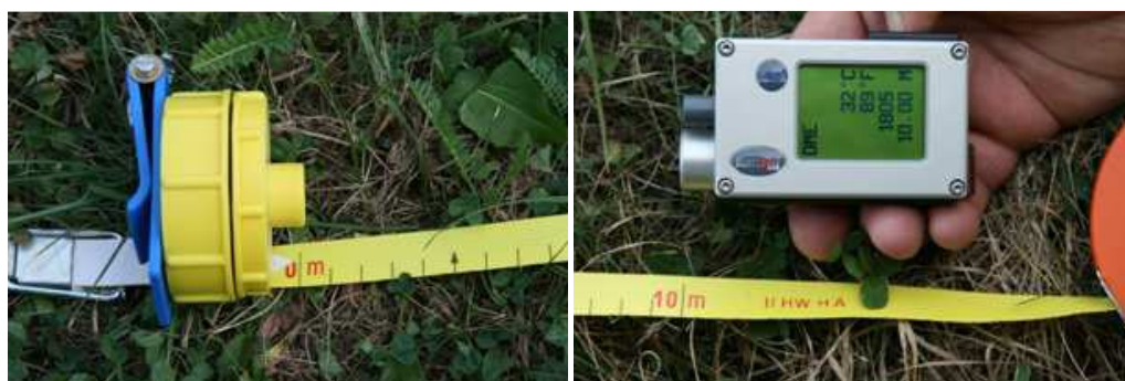
Obrázek č. 6: Z kalibrování Vertexu III. (Zdroj: Urbánek, 2009)
