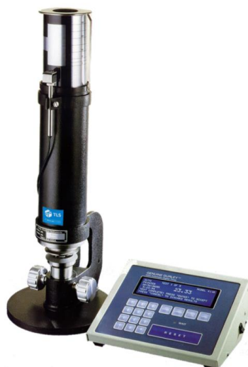
Obrázek 16 Příklad přístroje pro měření propustnosti podle Gurleye (Gurley Densometers Permeability, 2023)
