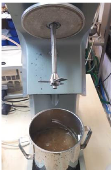
Obrázek 12 Laboratorní rozvlákňovač Lorentzen & Wettres
