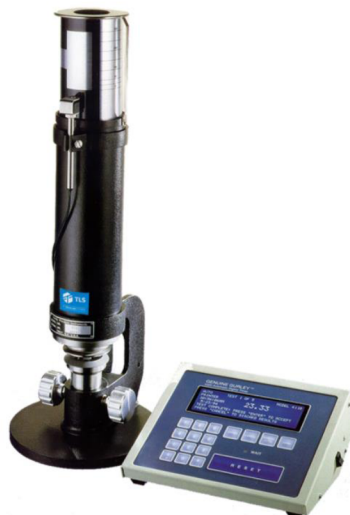
Obrázek 16 Přístroj pro měření propustnosti podle Gurleye (Gurley Densometers Permeability, 2023)
