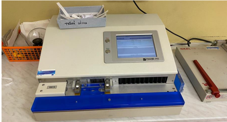
Obrázek 14 Laboratorní trhací zařízení FRANK-PTI
