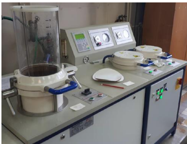
Obrázek 13 Laboratorní archovač RAPID-KÖTHEN RK-2A
