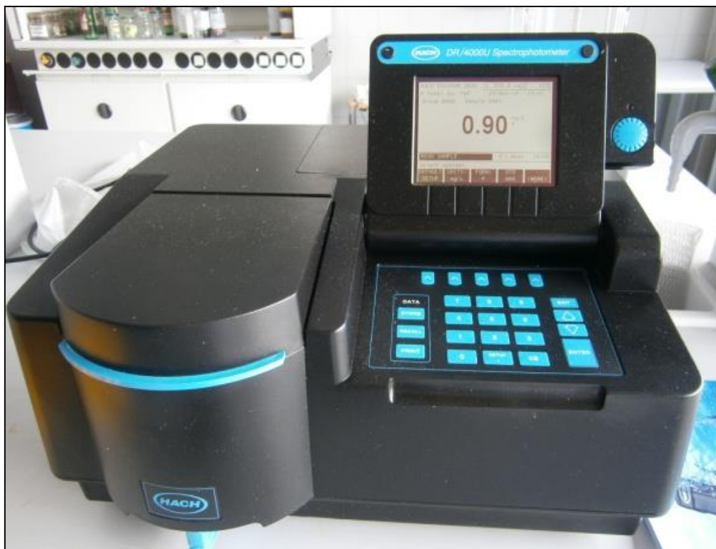
Obr. 2 Spektrofotometr HACH DR/4000
