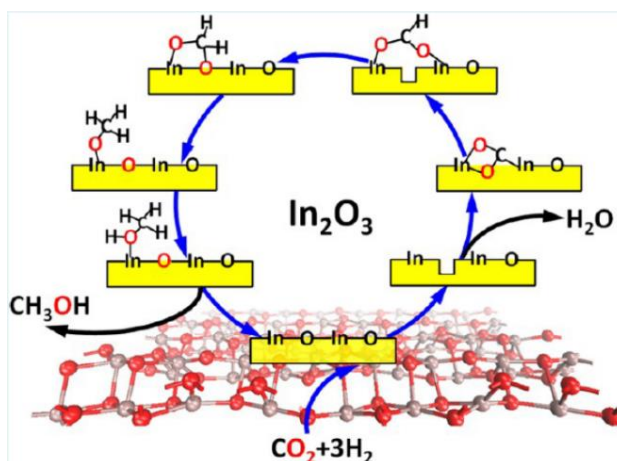
Obrázek 13: Proces vzniku metanolu na defektním povrchu In_2O_3 (27)
