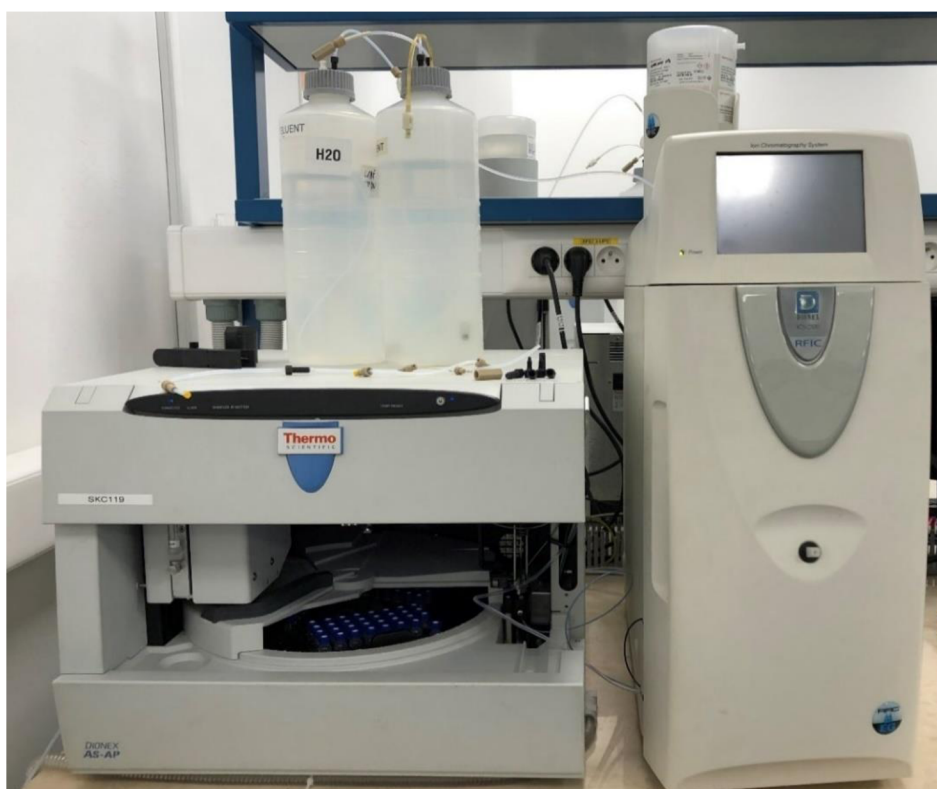
Obrázok 18 – Iónový chromatograf použitý na analýzu množstva voľného fluóru
