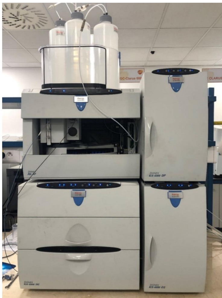
Obrázok 22—Íónový chromatograf použitý na analýzu množstva draslíka
