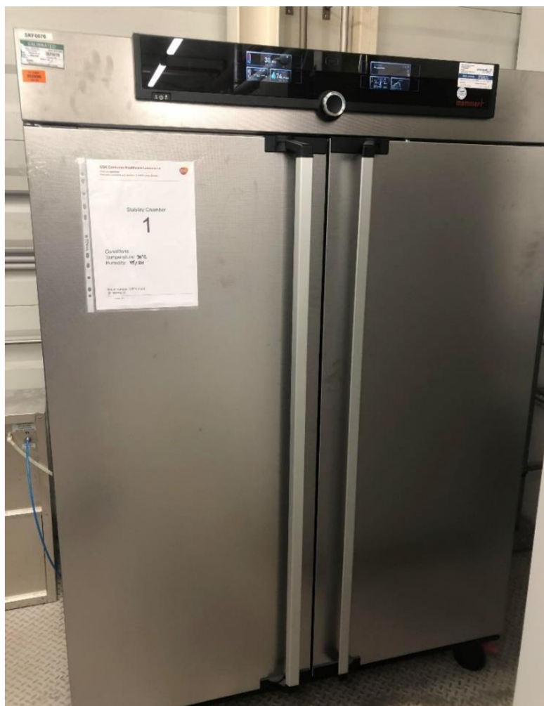
Obrázok 11 – Stabilitná komora s nastaviteľnými hodnotami teploty a relatívnej vlhkosti
