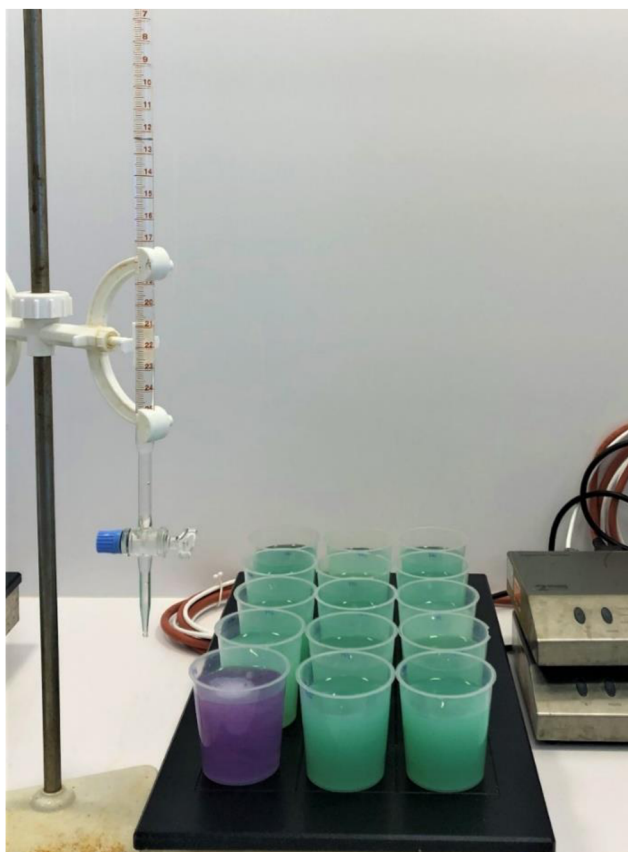
Obrázok 23 – Zmena zafarbenia roztoku vzorky pri dosiahnutí bodu ekvivalencie
