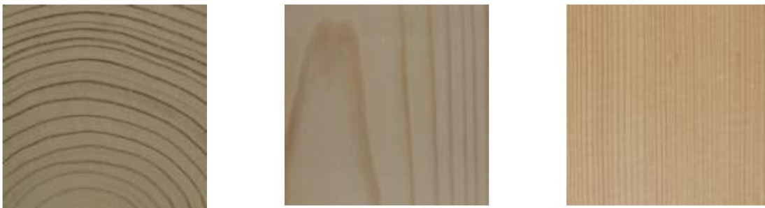
Obrázek 1 Zleva: příčný, tangenciální, radiální řez dřeva smrku (Zeidler 2012)
