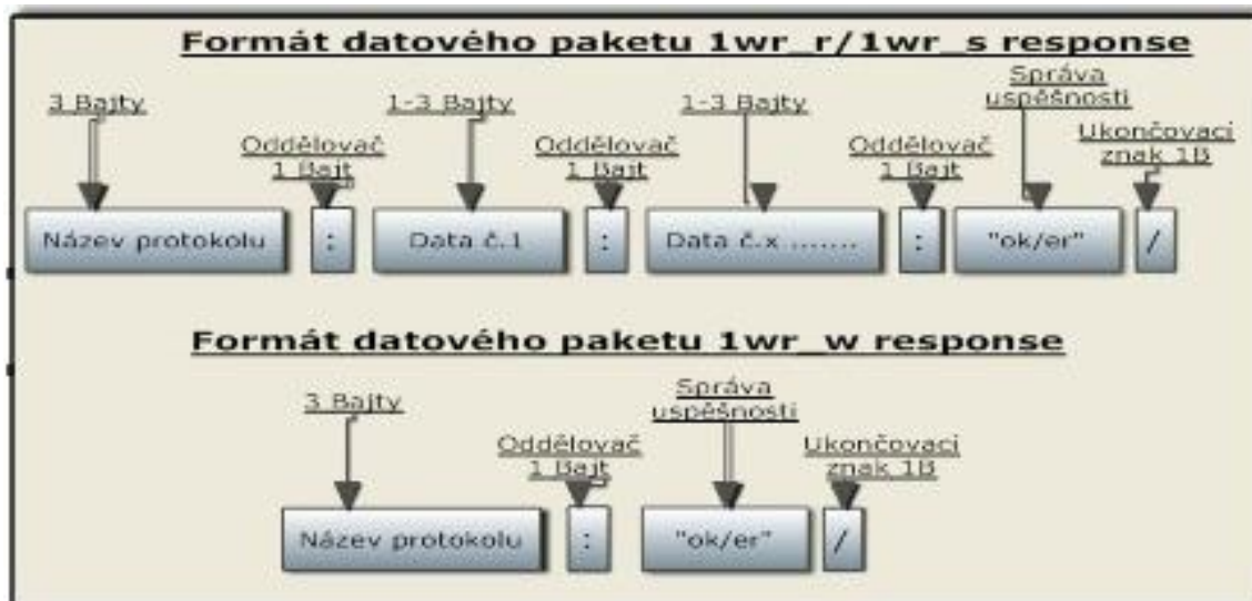
Obr. č. 32. Datový paket 1WIRE Slave-Master
