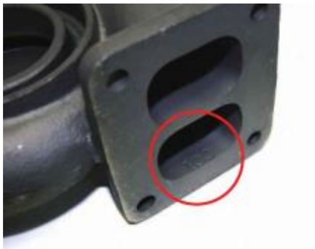
Obrázek 13 A/R poměr na vstupu výfukových plynů turbínové skříně [1]
