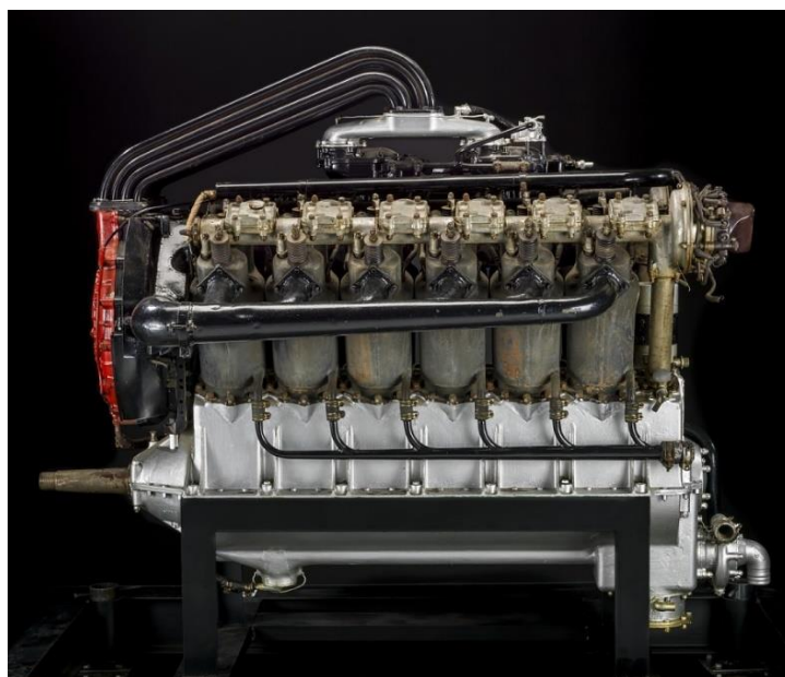
Obrázek 3 zážehový motor Liberty V12 osazený tubopřeplňováním [32]
