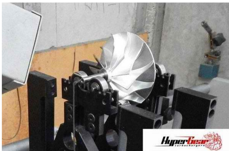
Obrázek 22 Kompresorové kolo na speciálním vyvažovacím přístroji [20]
