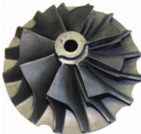
Obrázek 23 Vyvážené kompresorové kolo [1]
