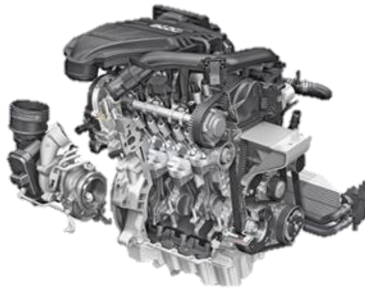
Obrázek 37 tříválcový zážehový motor VW Group 1.0 TSI [9]
