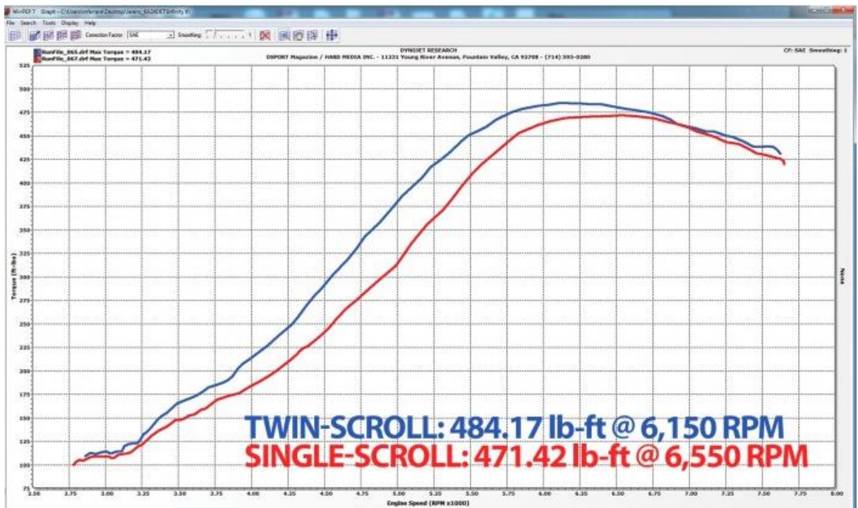
Obrázek 16 Porovnání křivek točivého momentu se systémem twin-scroll a bez něj [8]
