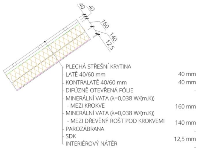
Obr. 26: Skladba střešní konstrukce
