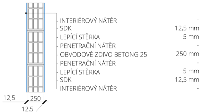
Obr. 24: Skladba vnitřní nosné stěny
