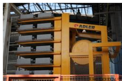
Obr. 3: Skladování tvárnic Betong automatickým skladníkem Adler [28]
