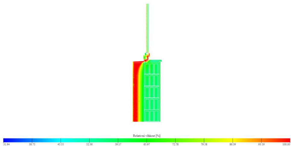
Obr. 121: Vlhkostní pole detailu napojení parapetu okna na obvodovou stěnu BETONG 25 - vnější zateplení
