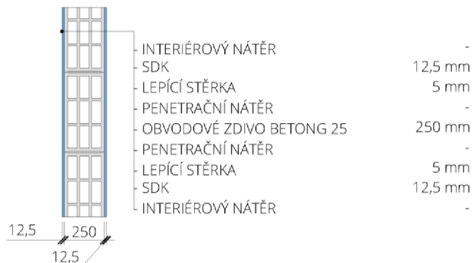
Obr. 24: Skladba vnitřní nosné stěny
