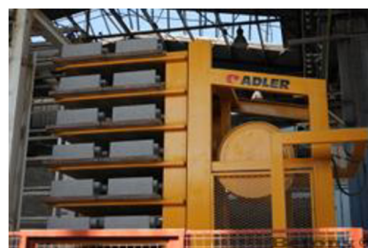
Obr. 3: Skladování tvárnic Betong automatickým skladníkem Adler [28]
