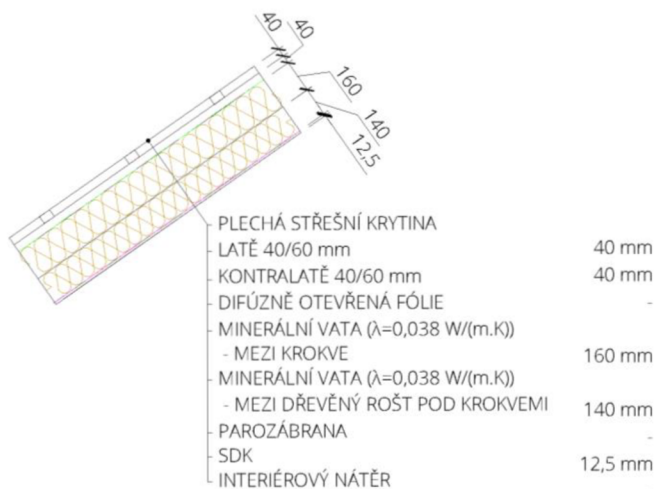
Obr. 26: Skladba střešní konstrukce
