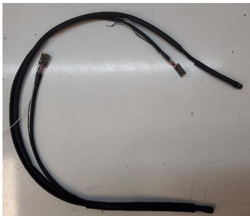
Obr. 60 Svazek horního ramene s připájenými zesilovači a připravenými smršťovačkami
