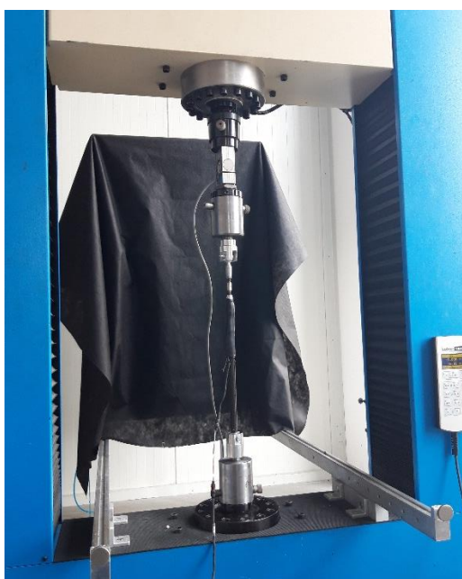
Obr. 75 Kalibrace na přístroji LabTest 6.500
