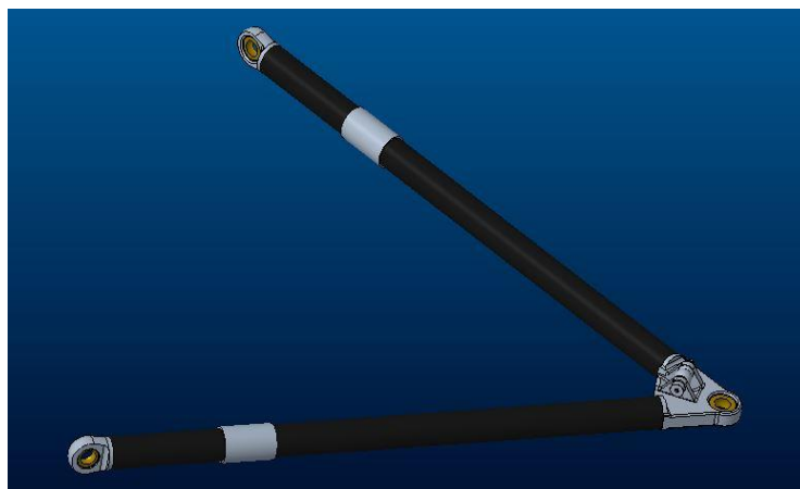
Obr. 36 Model spodního ramena s vlepěnými hliníkovými vložkami
