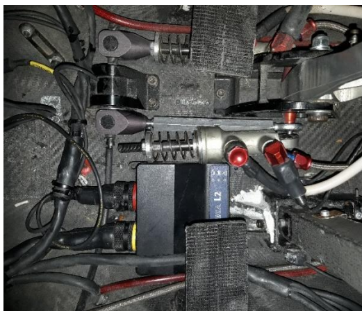
Obr. 111 Pohled do monokoku na brzdový systém vozu Dragon9, lze si povšimnout zapojené náhrady na místo předního brzdného válce. Na fotografii lze také vidět umístěný datalogger Omega L2
