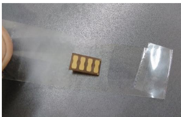
Obr. 44 Svorkovnice na přenášecí izolepě (odlepení pod úhlem 45°)
