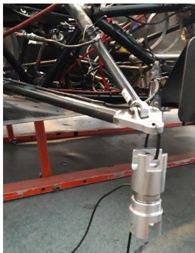
Obr. 91 Spodní rameno s pushrodem před kontrolní kalibrací
