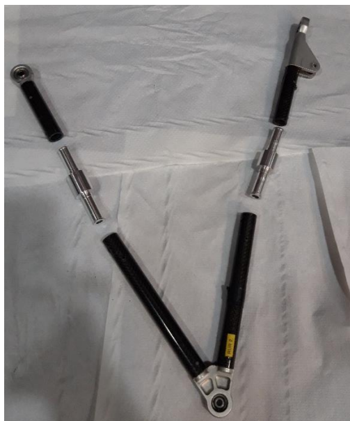
Obr. 37 Horní rameno s vložkami před nanesením lepidla
