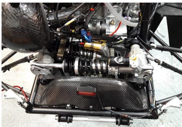
Obr. 70 Roll - Heave systém na voze Dragon9
