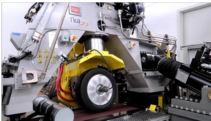
Obr. 9 Měřicí zařízení Flat-track [7]
