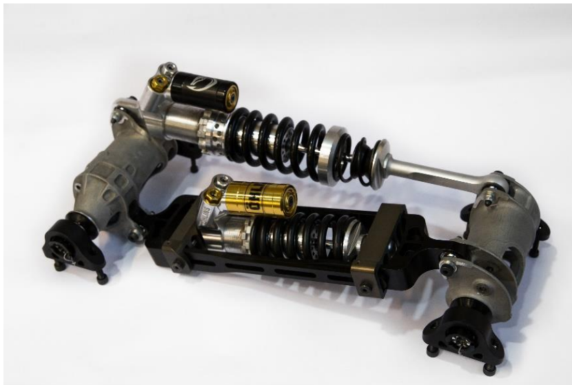
Obr. 68 Roll-Heave systém vozu Dragon9
