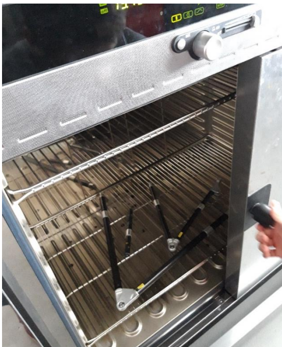
Obr. 39 Ramena vložená v troubě k vytvrzení lepidla za zvýšené teploty
