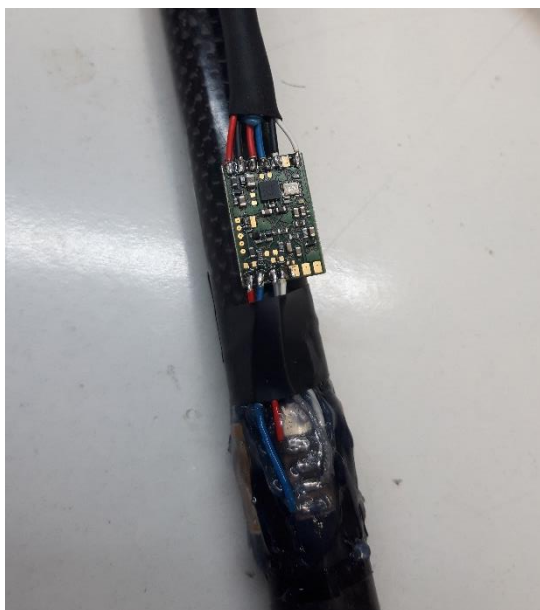
Obr. 54 Zapojený zesilovač ke gelem zakrytému tenzometrickému můstku
