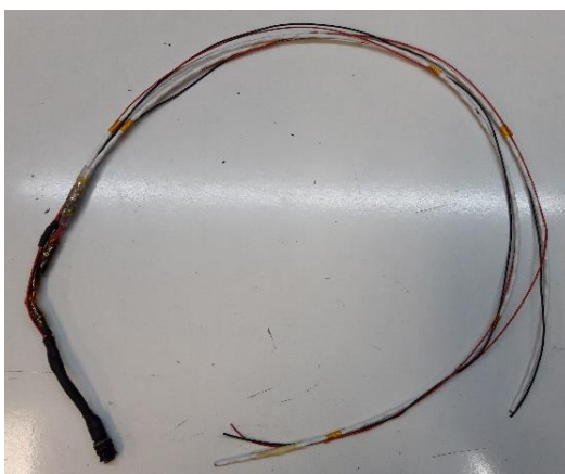
Obr. 59 Svazek spodního ramene s připravenými vodiči
