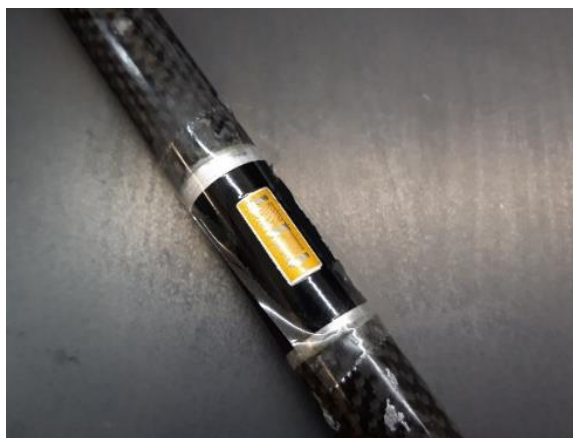
Obr. 46 Nalepený tenzometr s přenášečí izolepou
