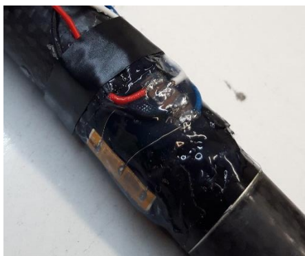
Obr. 48 Připájený a zakrytý tenzometrický můstek
