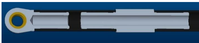
Obr. 35 Model hliníkové vložky pro nalepení tenzometru
