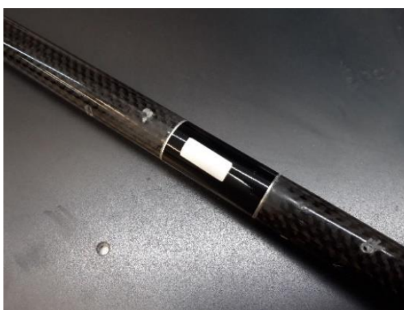
Obr. 41 Přípravek (lepicí folie) na nalepení tenzometru
