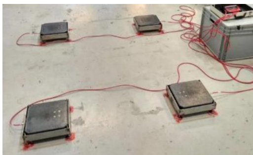
Obr. 110 Váhy pro rozvážení vozidla a nastavení geometrie
