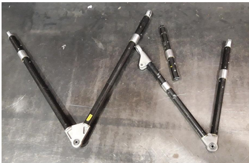
Obr. 40 Hotové závěsy s vlepenými hliníkovými vložkami
