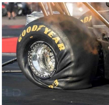
Obr. 6 Podélný skluz a deformace pneumatiky dragsterů při startu závodu [4]
