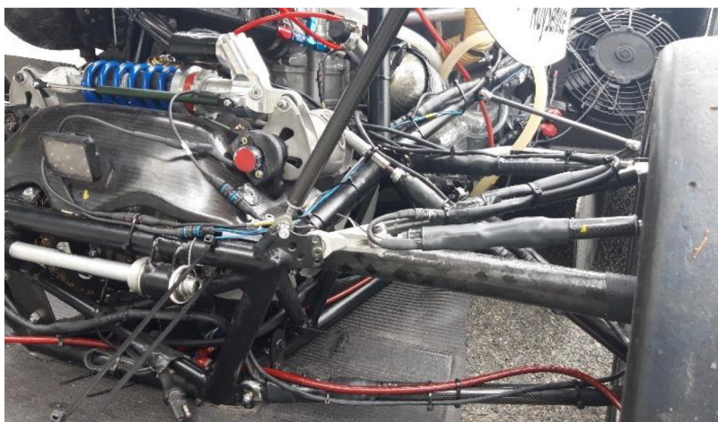
Obr. 112 Pohled na pravou zadní nápravu vozu Dragon 9 opatřenou tenzometry na závěsech
