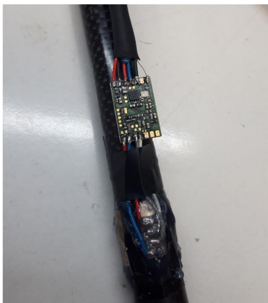
Obr. 54 Zapojený zesilovač ke gelem zakrytému tenzometrickému můstku
