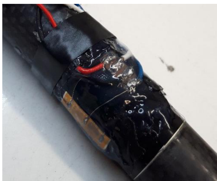
Obr. 48 Připájený a zakrytý tenzometrický můstek
