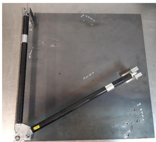
Obr. 38 Spodní rameno s hliníkovými vložkami usazené v přípravku pro výrobu
