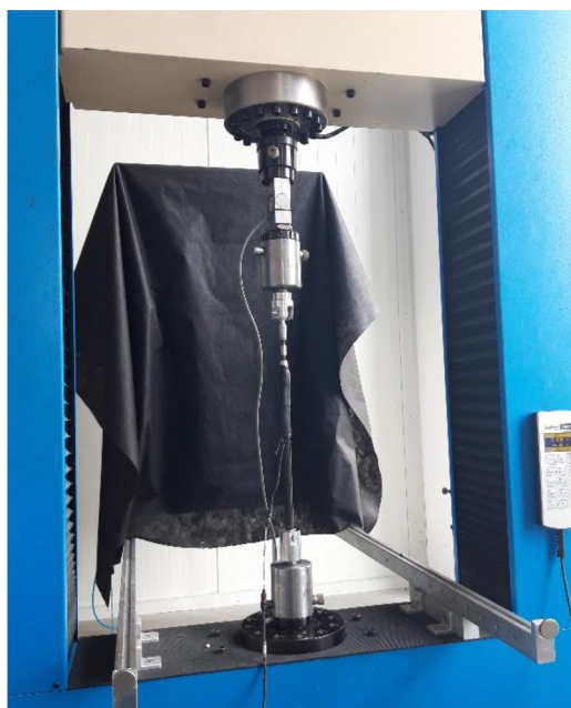
Obr. 75 Kalibrace na přístroji LabTest 6.500
