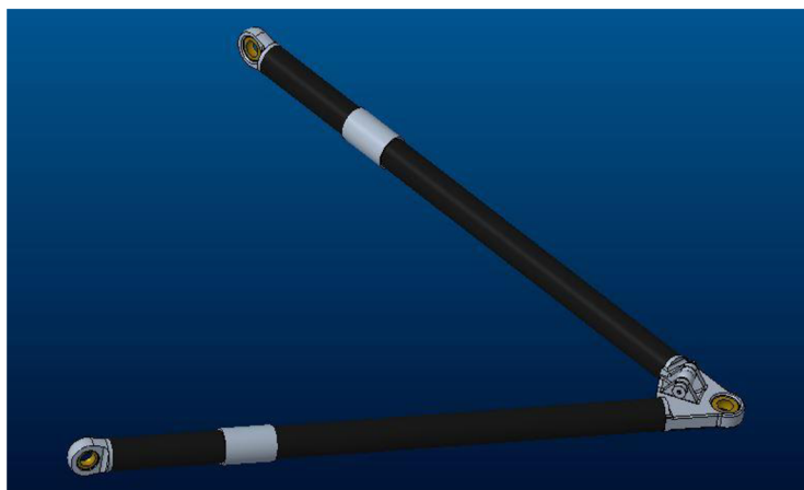
Obr. 36 Model spodního ramena s vlepěnými hliníkovými vložkami
