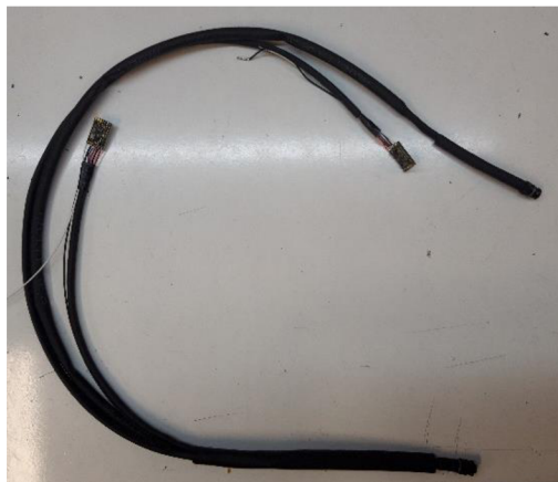
Obr. 60 Svazek horního ramene s připravenými zesilovači a připravenými smršťovačkami
