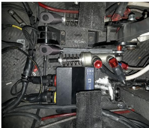
Obr. 111 Pohled do monokoku na brzdový systém vozu Dragon9, lze si povšimnout zapojené náhrady na místo předního brzdového válce. Na fotografii lze také vidět umístěný datalogger Omega L2
