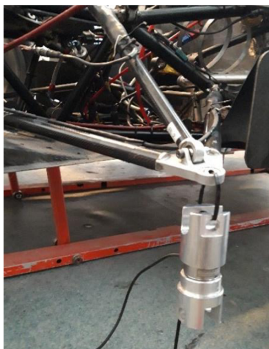
Obr. 91 Spodní rameno s pushrodem před kontrolní kalibrací
