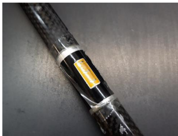
Obr. 46 Nalepený tenzometr s přenášečí izolepou
