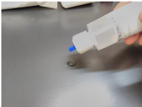
Obr. 43 Neutralizace pracovní plochy
