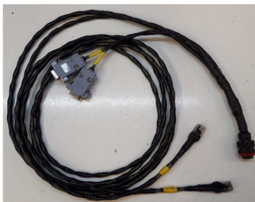
Obr. 64 Připojovací kabel k počítači umožňuje připojení k dataloggeru Omega L2, řídicí jednotce F88 a také připojení na CAN komunikace v případě diagnostiky problémů s komunikací
