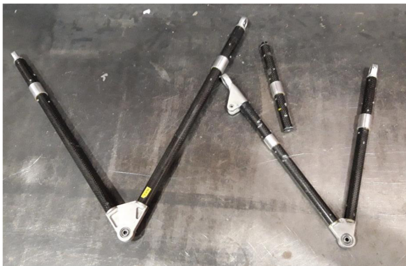
Obr. 40 Hotové závěšy s vlepenými hliníkovými vložkami
