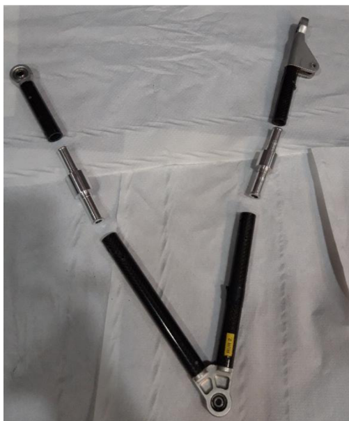
Obr. 37 Horní rameno s vložkami před nanesením lepidla
