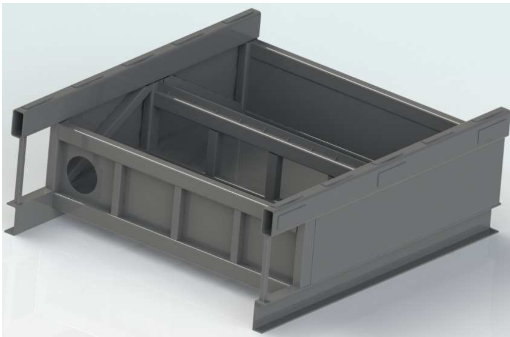
obr. 28 Zakrytovaný rám stroje s otvorem pro odsávání
