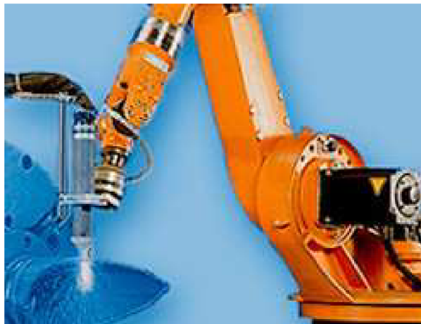
obr. 6 Řezání laserem pomocí robotu KUKA [9]
