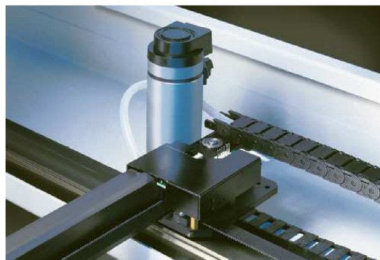
obr. 11 Stejnosměrný zpětnovazební servomotor s vysokými otáčkami [12]
