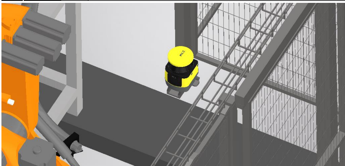
Obr. 16) Umístění laserového skeneru u vstupu plechů do pracoviště.
