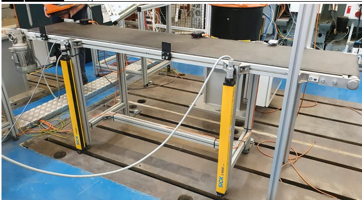
Pásový dopravník bez ochrany proti popálení a s nevhodně umístěnými optickými bránami.
