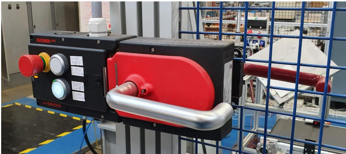
Obr. 15) Dostupný, ale nepoužívaný multifunkční box zámku EUCHNER MGB.
