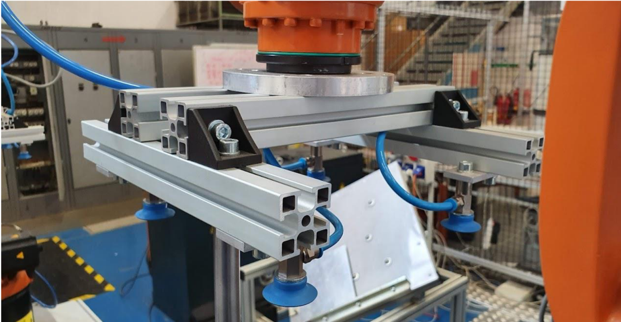
Ostré hrany koncových efektorů vlastní konstrukce.
