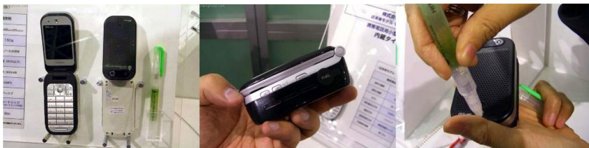
Obr.11: Mobilní telefon a plnicí pero, nadměrná tloušťka při pohledu z boku a plnění telefonu.[11]
