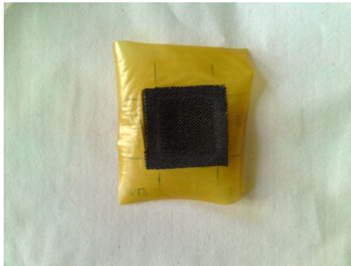
Obr.94: Membrána s nalisovanými elektrodami
