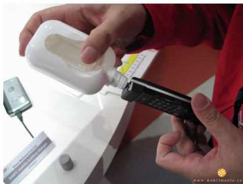
Obr.15: Plnění zásobníku stejným způsobem jako u zapalovače.[15]
