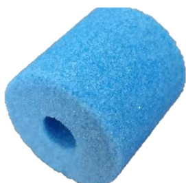
Obr. 3.8 Brousicí kotouč 97A 802 I5 V112.
