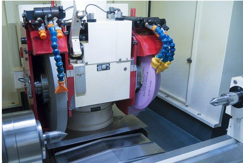
Obr. 2.19 Pohled na vnitřní uspořádání brousicího a pracovního vřeteníku hrotové brusky Studer S31 – stroj patří k vybavení firmy SLB, spol. s r.o.
