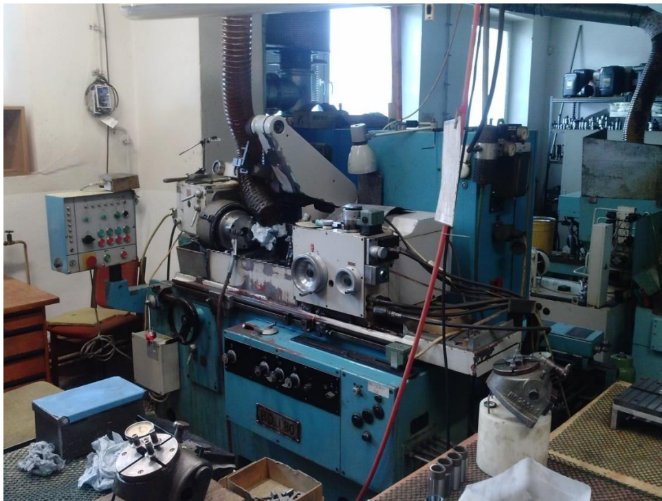
Obr. 2.20 Pohled na brusku na díry BDU 80 s upínáním obrobku na elektromagnetickou desku – stroj patří k vybavení firmy SLB, spol. s r.o.
