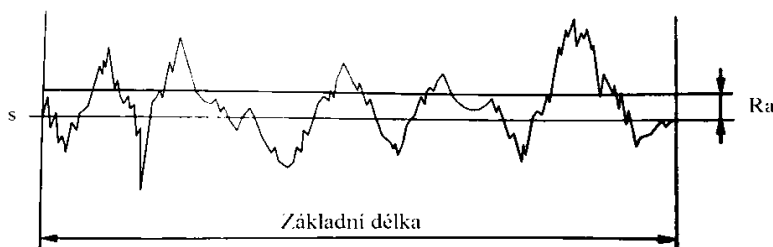
Obr. 3.1 Znárodnění významu parametru Ra, kde s značí střední čaru profilu drsnosti [13, 14].
