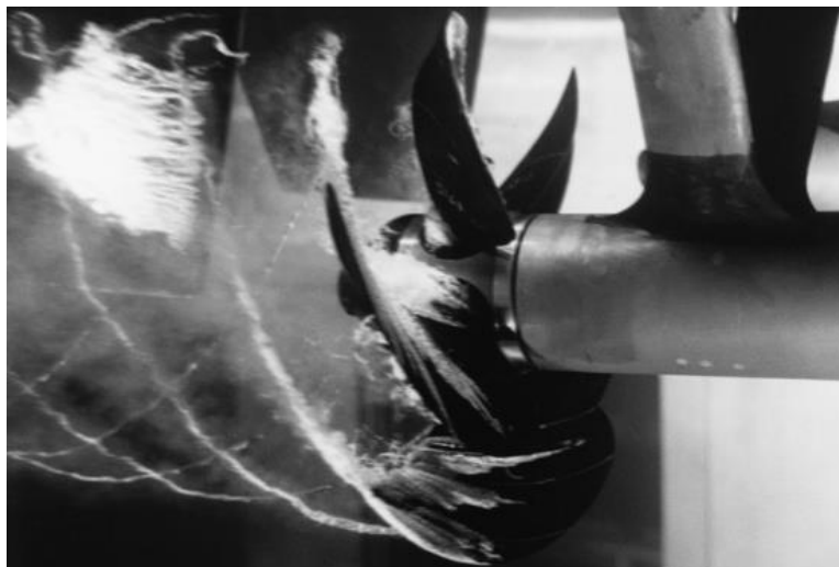
Obrázek 4: Experiment hydrodynamické kavítace ve vodním tunelu [4]
