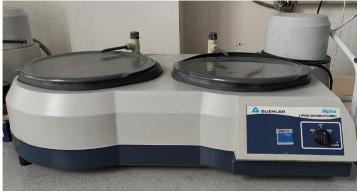
Obrázek 23: Dvourychlostní dvoukotoučová bruska a leštička Alpha od firmy BUEHLER
