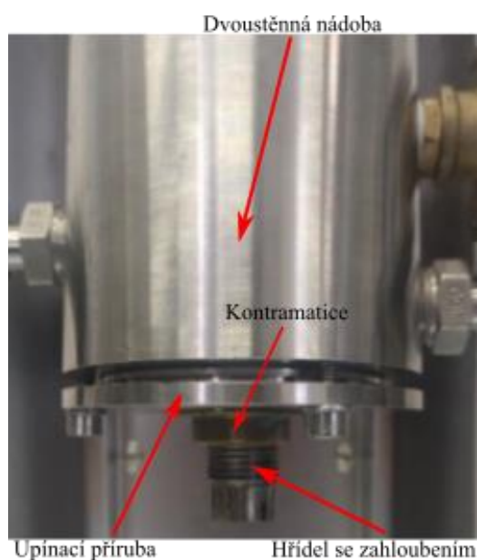
Obrázek 29: Upevnění upínací příruby do dvoustěnné nádoby
