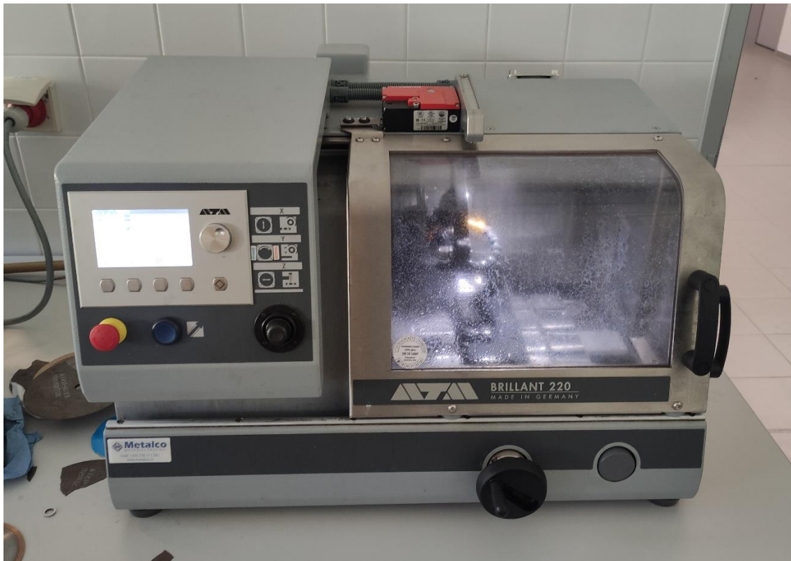
Obrázek 48: Přesná pila BRILLANT 220 od firmy ATM
