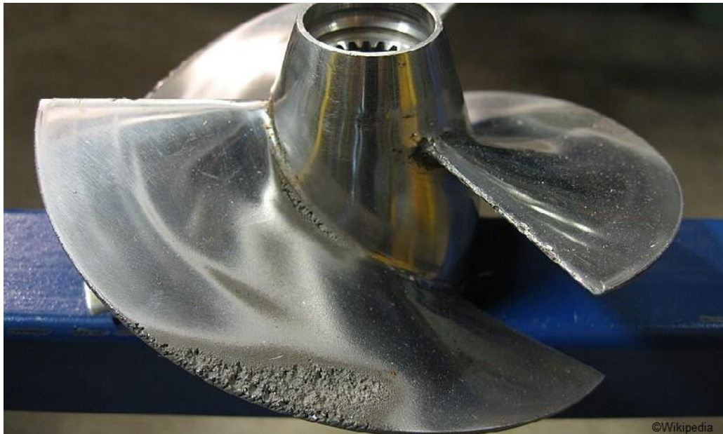
Obrázek 3: Lodní šroub poškozený kavitační erozí [4]
