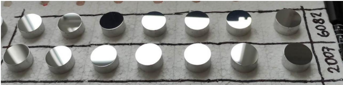
Obrázek 26: Zkušební vzorky EN AW-2007 a EN AW-6082 po fázi finálního leštění
