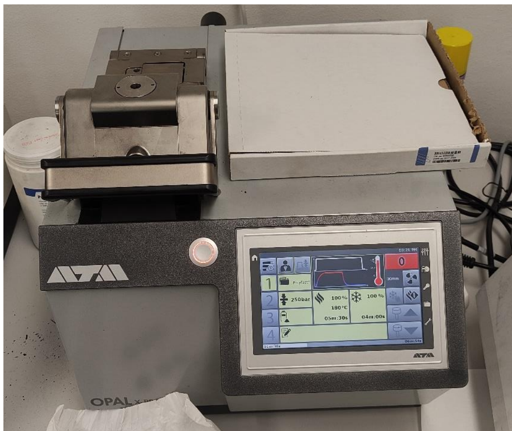
Obrázek 49: Modulární metalografický lis OPAL X-Press
