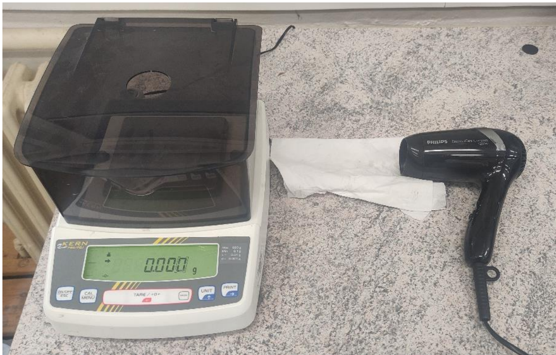
Obrázek 35: Laboratorní váha KERN PBS/PBJ společně s fénem
