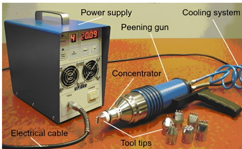
Obrázek 8: Sestava ultrazvukového systému od společnosti SINTES [15]
