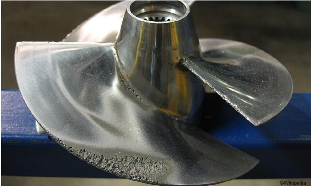
Obrázek 3: Lodní šroub poškozený kavitační erozí [4]
