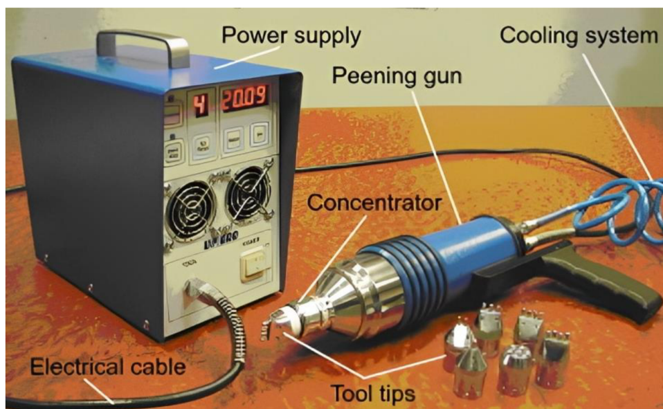
Obrázek 8: Sestava ultrazvukového systému od společnosti SINTES [15]
