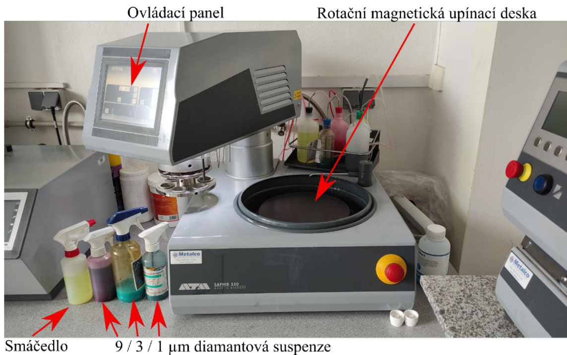
Obrázek 25: Jednokotoučová bruska a leštička SAPHIR 550 od firmy ATM s příslušenstvím
