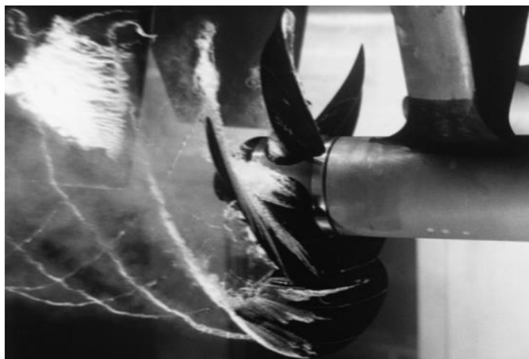
Obrázek 4: Experiment hydrodynamické kavítace ve vodním tunelu [4]
