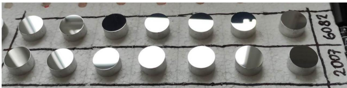
Obrázek 26: Zkušební vzorky EN AW-2007 a EN AW-6082 po fázi finálního leštění
