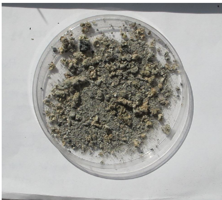
Obr. 8. Popel agropelety z řepkové slámy
