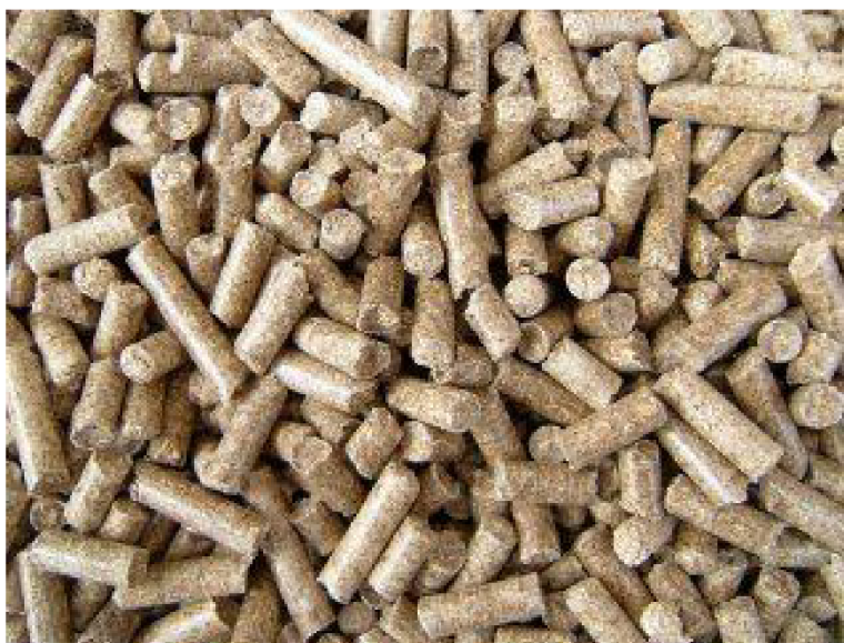
Obr.9. Agropelety z řepkové slámy[13]
