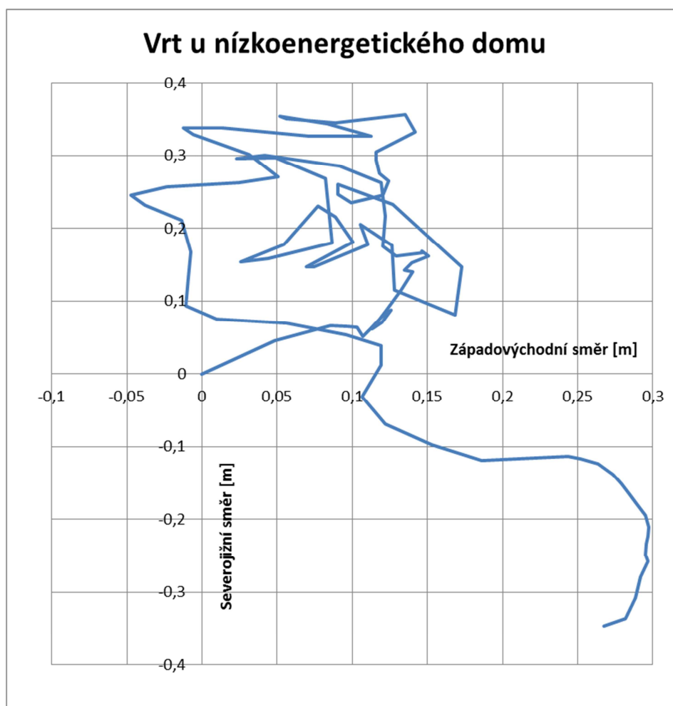
Obr. 9: Půdorysný nárys průběhu střednice měřicí trubky vrtu u nízkoenergetického domu, bod [0,0] je u zhlaví.
