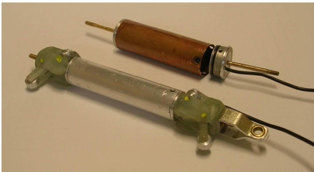
Obr. 6: Sestavená menší „druhá verze“ sondy, předchozí větší verze otevřená a bez vodičích vozíků v pozadí.
