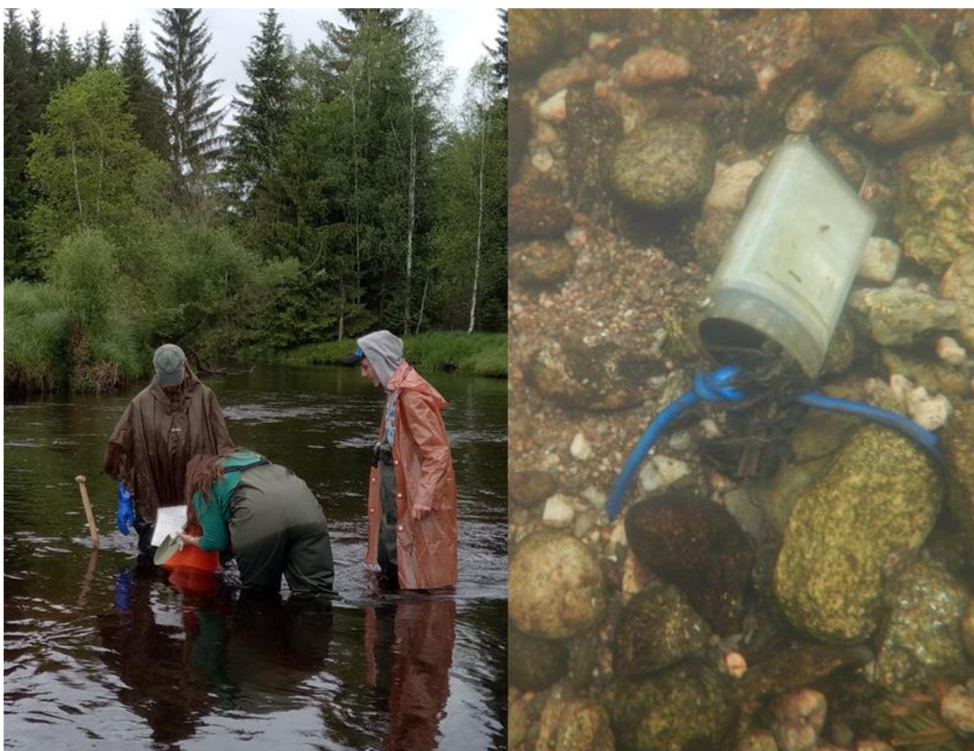
Obrázek 8 A Instalce teploměru do dna a práce s aquaskopem a B výsledná poloha teploměru nade dnem, který by měřil teplotu (°C) a osvit (lux) s hodinovým intervalem.
