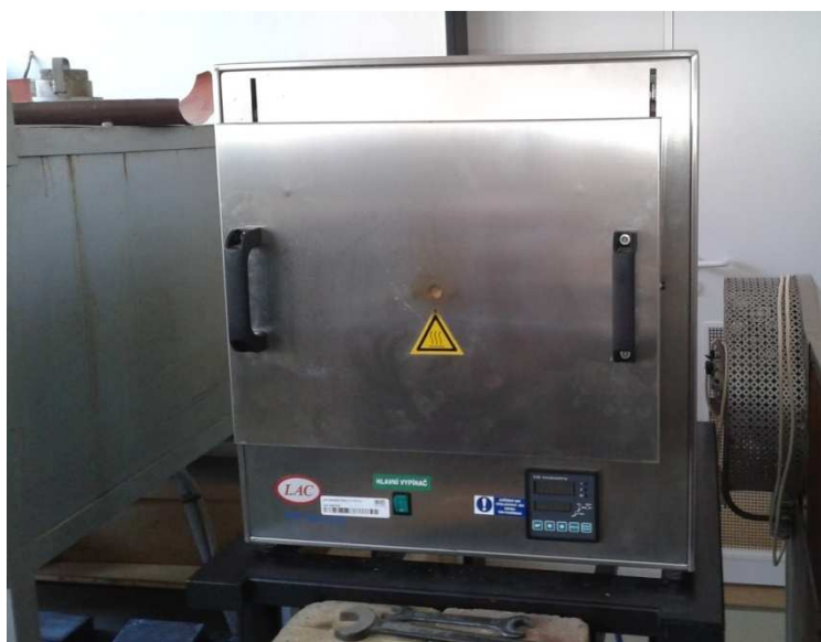
Obrázek 2: Pec na ohřev vzorků typu LAC LH 15/13S
