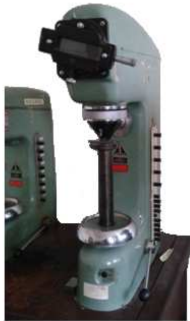
Obrázek 7: Podstata zkoušky dle Vickerse a zobrazení vtisku na stínítku
