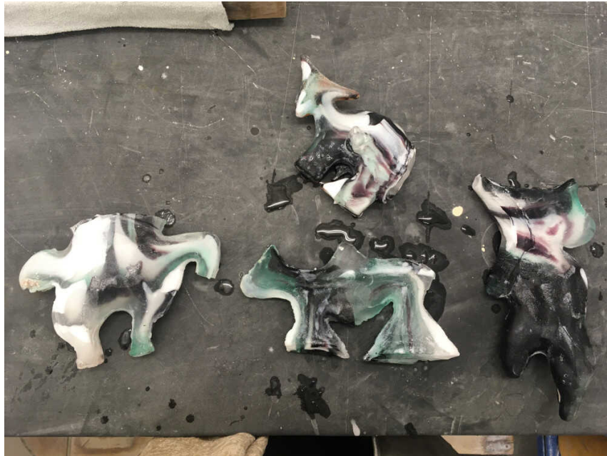
Obrázek 3.12: Skleněné plastiky po uříznutí násypnice
