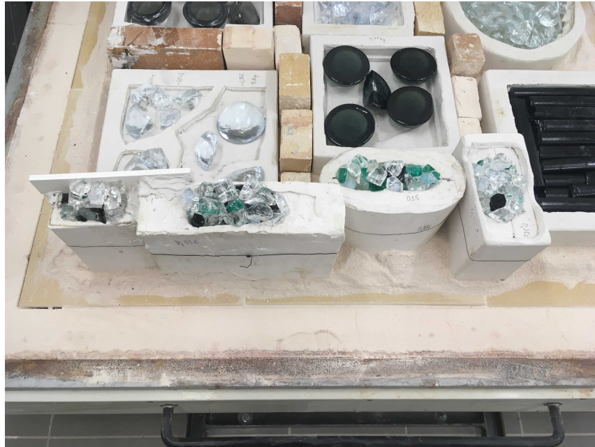
Obrázek 3.10: Sklo připravené ve formách na tavení
