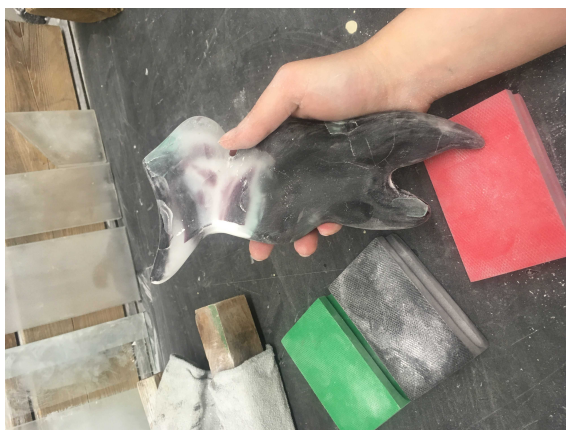
Obrázek 3.13: Zušlechťování brusnými houbičkami
