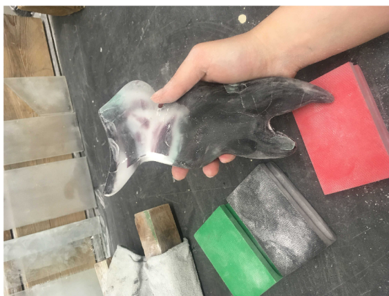
Obrázek 3.13: Zušlechťování brusnými houbičkami
