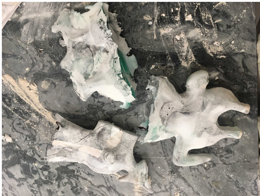
Obrázek 3.10: Sklo připravené ve formách na tavení
