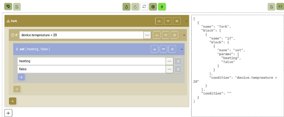
Obrázek 4.7: Ukázka demo aplikace vizuálního editoru. Na levé straně obrázku se nachází grafický editor tvořen jednotlivými příkazy. Příkaz s označením if je složeným příkazem s výrazem jako vstupním argumentem. Příkaz s označením set podporuje více vstupních argumentů textového typu. Na pravé straně obrázku je serializovaná podoba programu ve formátu JSON [12].
