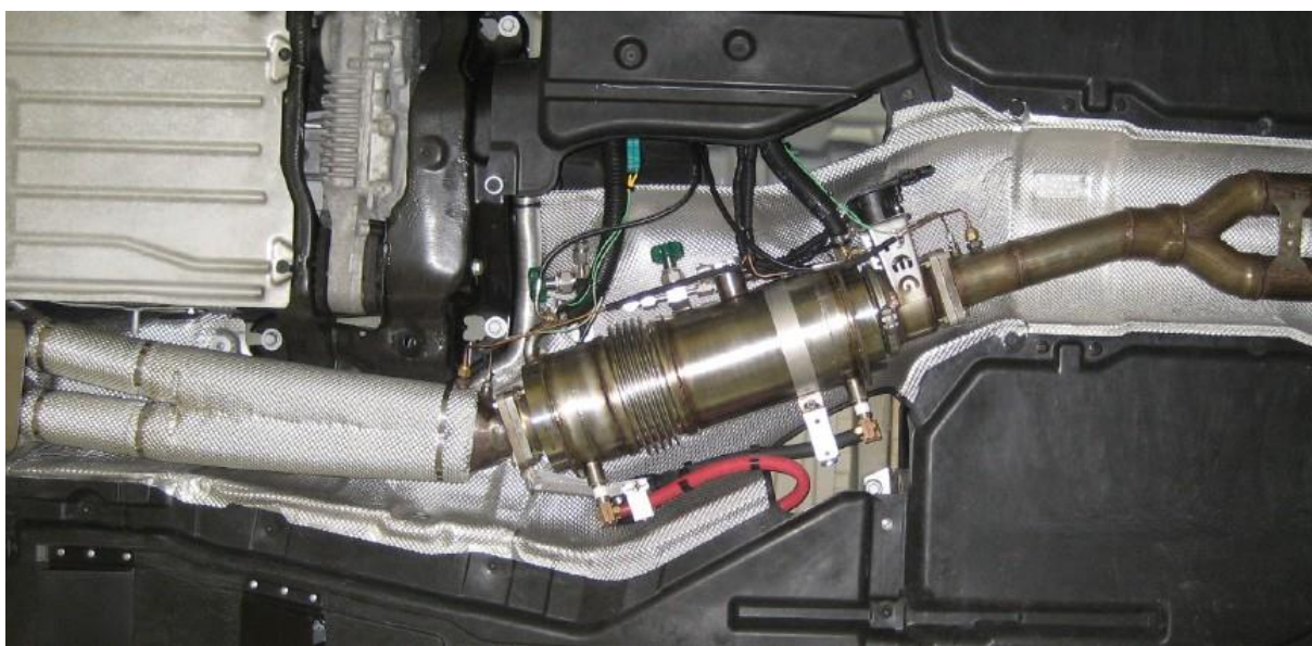
Obrázek 21: TEG ve vozidle BMW X6 [30]
