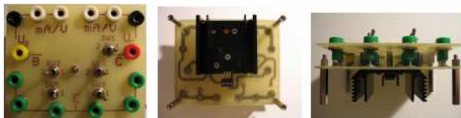
Obr. 5.5 Fotodokumentace přípravku pro měření vlastností bipolárních tranzistorů.
