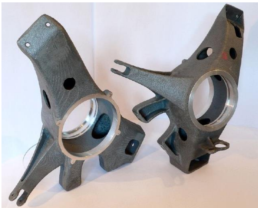
obr. 22 Těhlíce vozu Formule Student odlévané ze slitiny hliníku [5]
