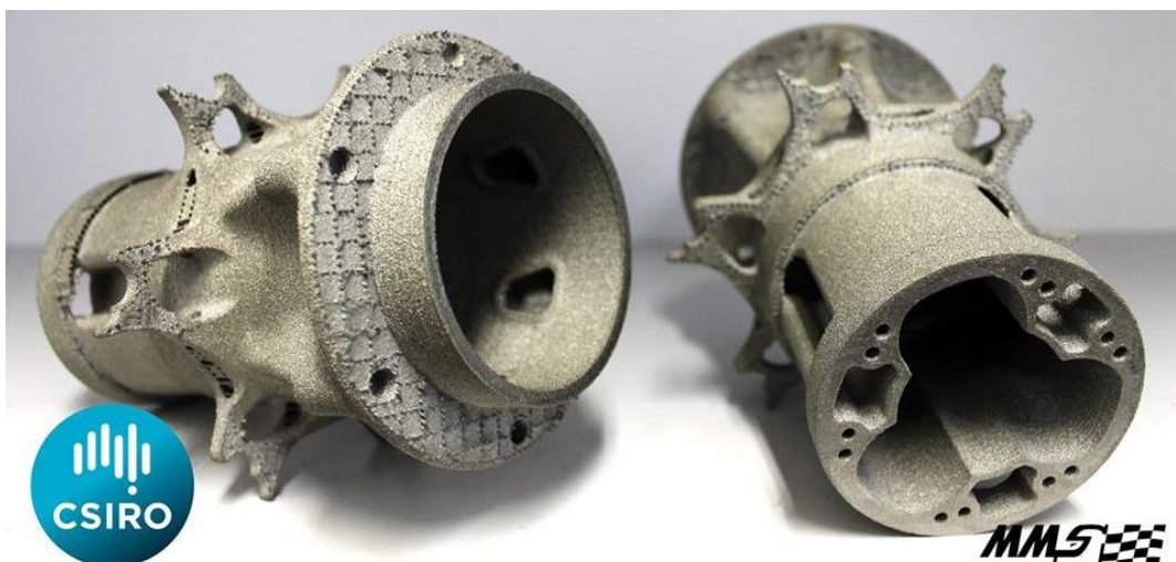
obr. 26 Náboje kola týmu Monash Motorsport z titanové slitiny [22]
