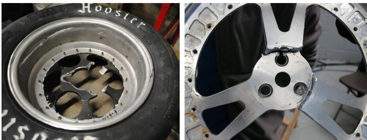
obr. 7 Následky použití kuželových šroubů a špatného návrhu středu kola. [4]
