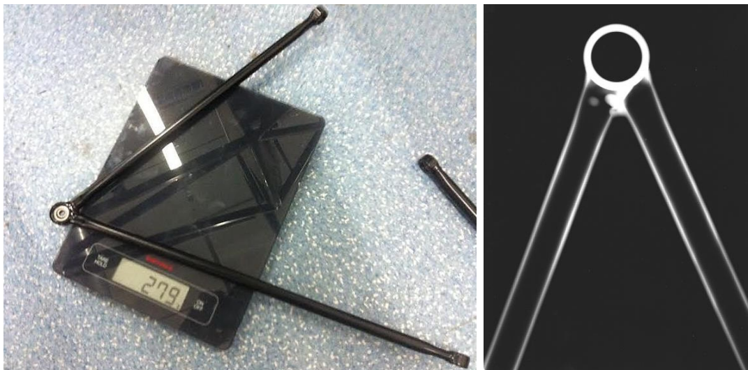
obr. 21 Svařovaná ramena zavěšení vozu Dragon 4 a výsledky jejich rentgenové kontroly
