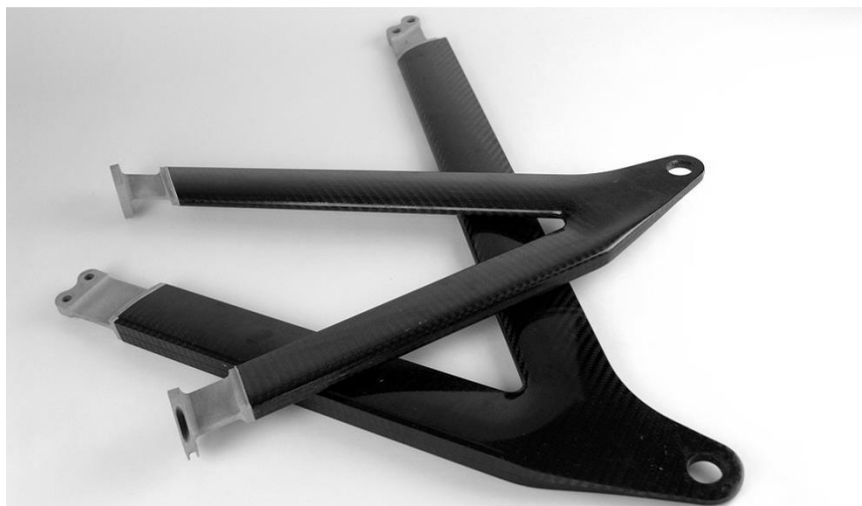
obr. 12 Ramena zavěšení kola z kompozitního materiálu zakončené pružnými břity. [11]
