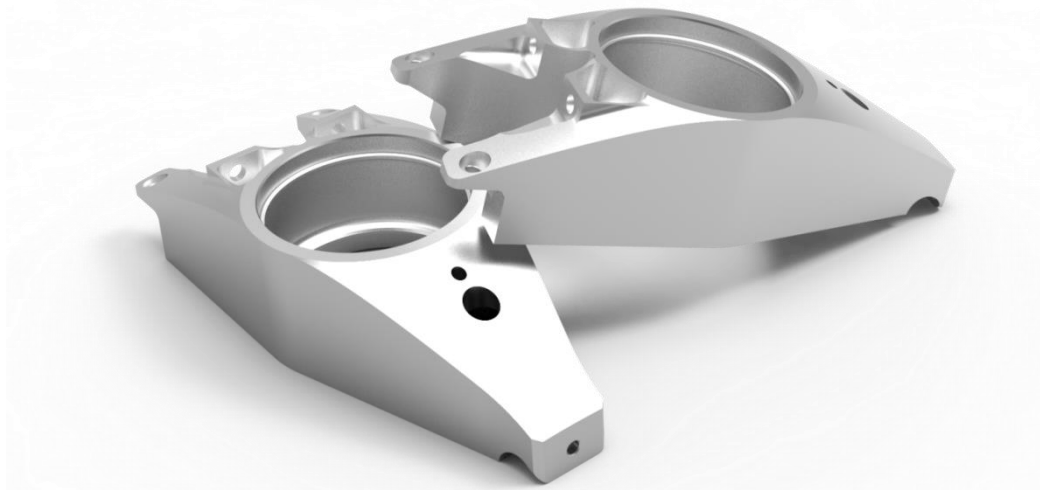
obr. 47 Těhlice vozu Dragon 4 z hliníkové slitiny EN AW 7075
