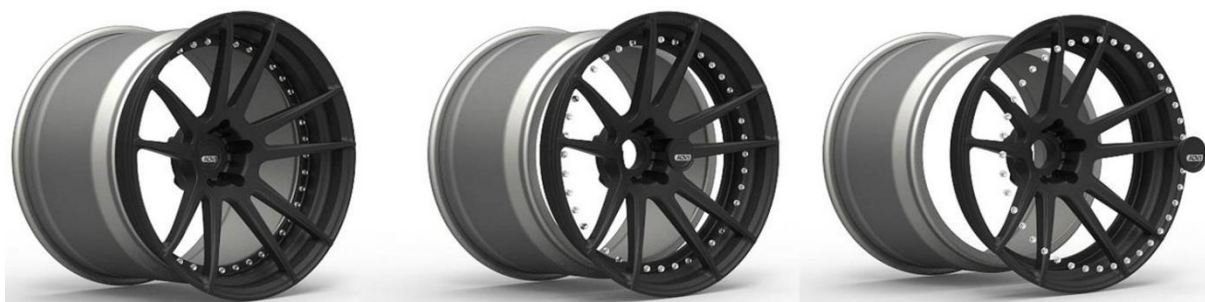
obr. 5 Dvoudílná kola z lehkých slitin pro sériová vozidla. [7]
