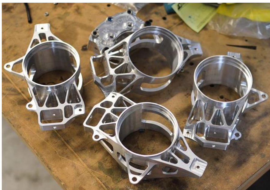
obr. 25 Obráběné těhlice týmu Formula Sae z University of Washington [22]
