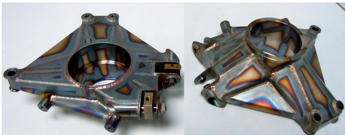
obr. 20 Svařované těhlice z ocelového plechu vozu Formule Student [20]
