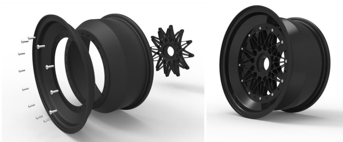
obr. 31 Kola vozu Dragon 3 s límcí společnosti Metalex a vlastním návrhem středu kola.
