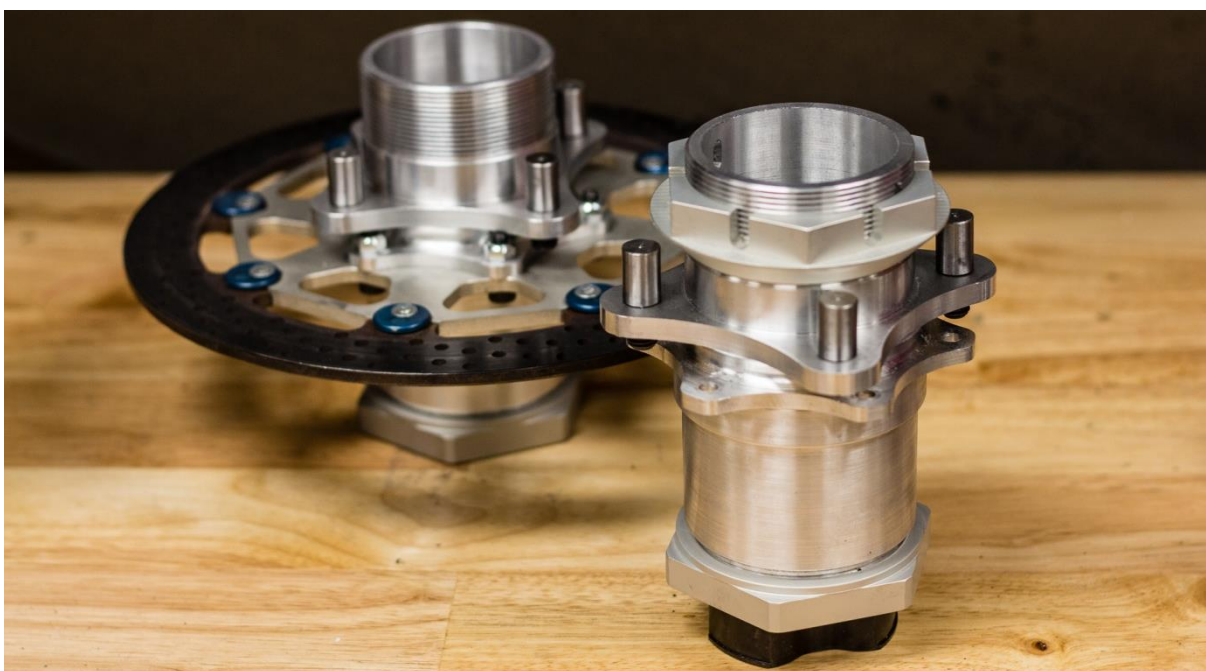
obr. 23 Zadní náboje z hliníkové slitiny s vložkou pro kloub poloosy [21]
