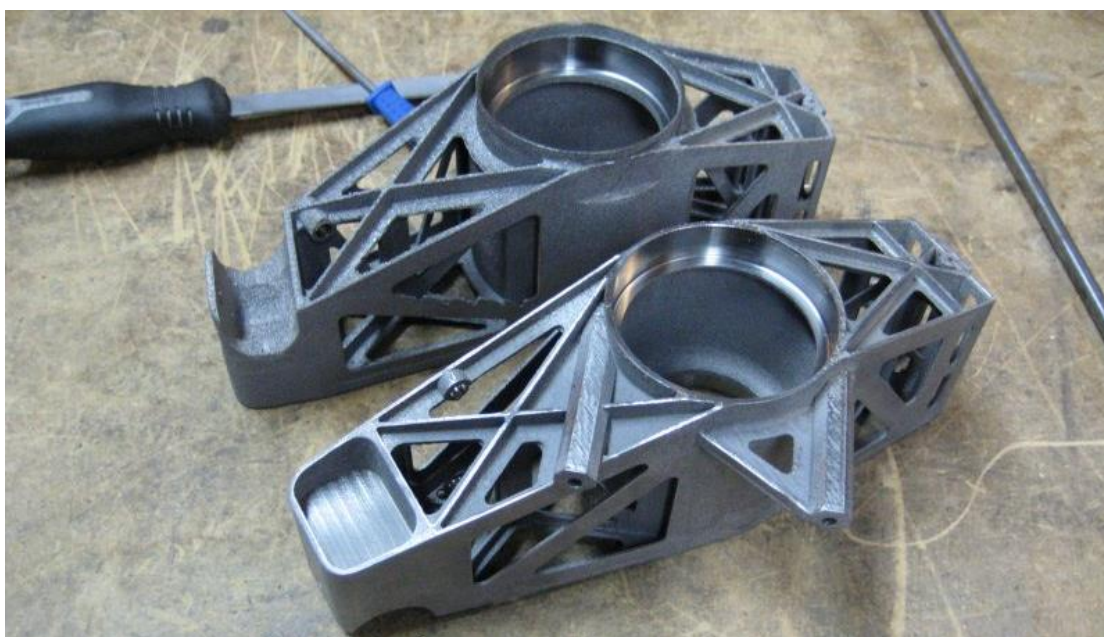
obr. 27 Těhlice vyrobené technologií Rapid Prototyping týmu Chalmers [23]
