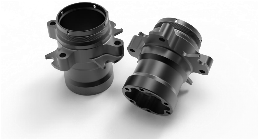
obr. 49 Kolové náboje vozu Dragon 4 s tvrdou eloxací v černém provedení
