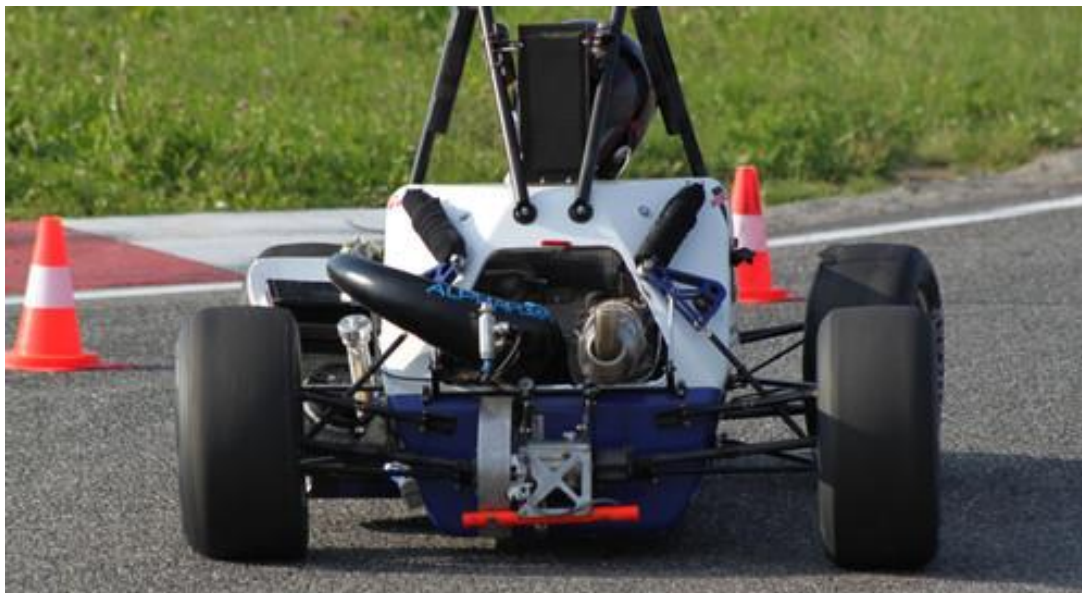
obr. 3 Ukázka důsledku nízké tuhosti uložení kola [4]
