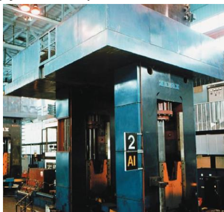
Obr. 43 Hydraulický lis CTH 250 [36].
