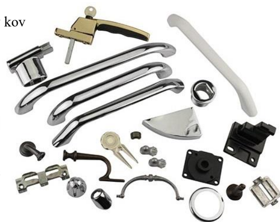
Obr. 8 Odlitky vyráběné litím pod tlakem [14].
