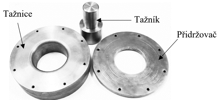
Obr. 27 Funkční části nástroje [30].
